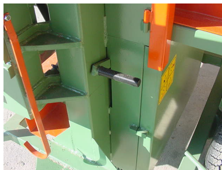
Esempio di protezione cinghie di trasmissione
