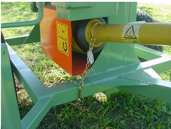
Sistema di trasmissione del moto modificato con albero cardanico protetto, cuffia conforme e catenelle antirotazione
