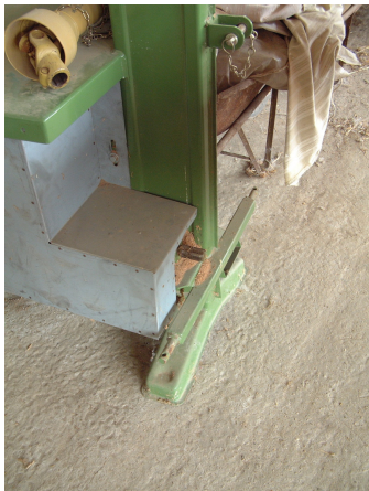
Esempio di albero cardanico non protetto
