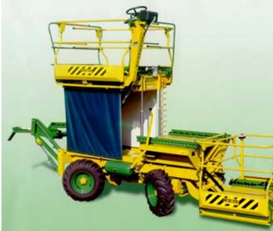
Particolare attenzione va prestata al sistema di sollevamento della piattaforma in quanto il meccanismo può dare origine a schiacciamenti e a cesoiamenti, per evitare questi pericoli è necessari disporre delle barriere che impediscano all'operatore di interporre tra le barre metalliche del pantografo di sollevamento della piattaforma (es. paratie anche non rigide, come teli autoavvolgenti).
