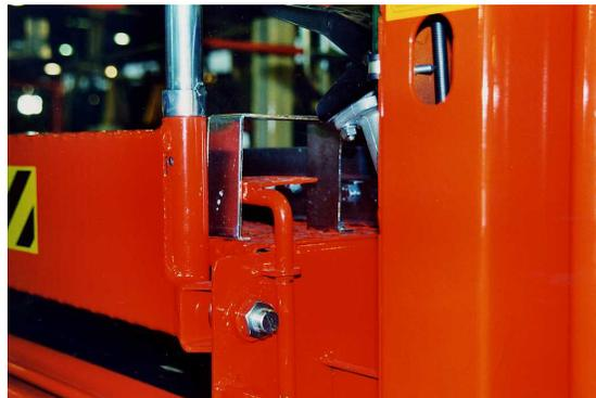
Fig. n 6 Comando di traslazione della piattaforma non protetto e protetto
