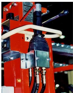
Fig. n 7 Comando di avanzamento ad azione mantenuta
