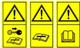
**1. ATTENZIONE** - Le operazioni di regolazione e manutenzione devono essere eseguite dopo aver letto il manuale d'uso e manutenzione, a macchina ferma e chiave disinserita.
