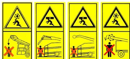
**8. ATTENZIONE -PERICOLO** di schiacciamento e ferimento. Non sostare e passare sotto la fresa durante il funzionamento.
