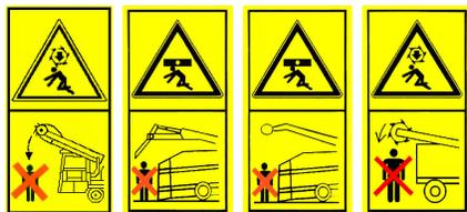
**9. ATTENZIONE – PERICOLO** di schiacciamento e ferimento. Non sostare o passare sotto il braccio desilatore
