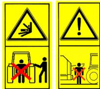
**5. ATTENZIONE** - Non sostare fra trattrice e operatrice con motore acceso e presa di potenza inserita.
