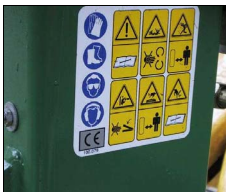
Apposizione non corretta di pittogrammi di sicurezza
