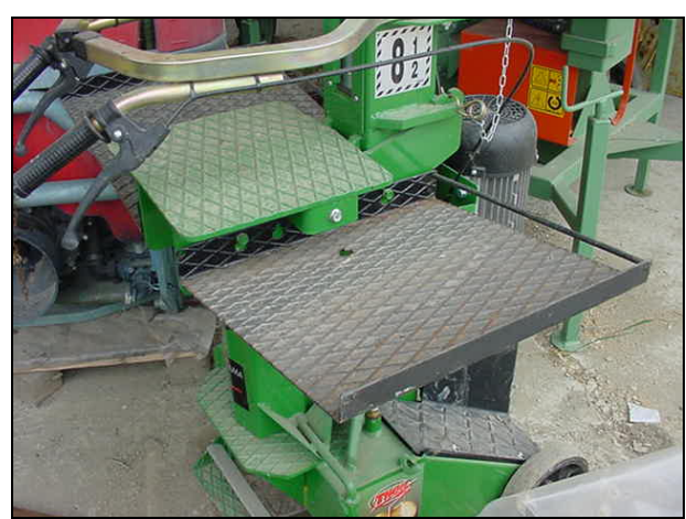
Spaccalegna verticale adeguato alla norma UNI EN 609-1
