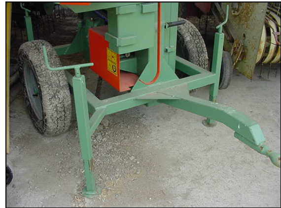
Spaccalegna verticale adeguato alla norma EN ISO 4254-1
