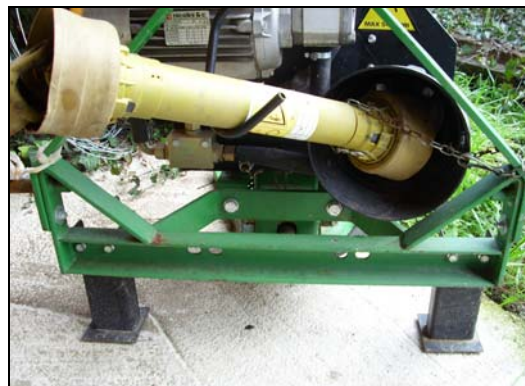
Piede di appoggio conforme alla EN ISO 4254-1
