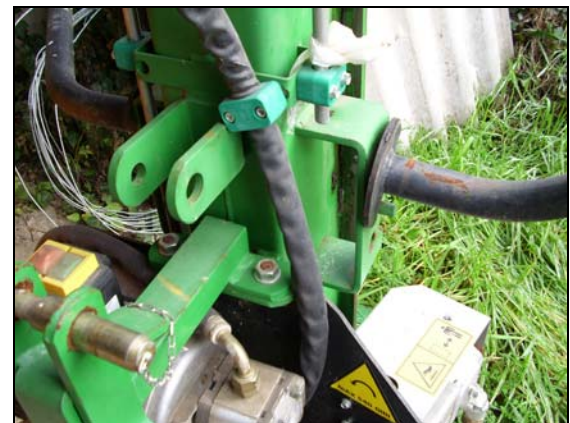
Spaccalegna verticale a cuneo adeguato alla norma EN ISO 4254-1
