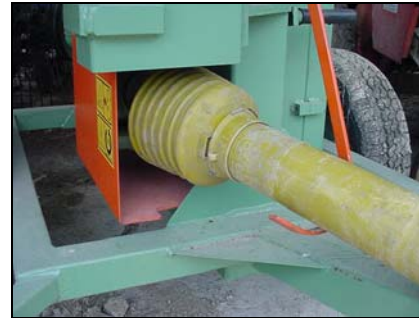
Albero cardanico protetto e supportato
