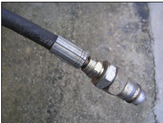
Tubi idraulici senza protezioni
