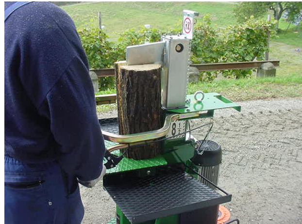
Spaccalegna verticale adeguato alla norma UNI EN 609-1
