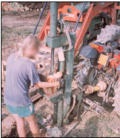
Spaccalegna verticale con cuneo a pedale, senza protezioni
