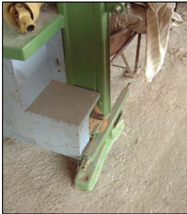
Presa di potenza cardanica con protezioni insufficienti
