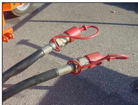
*Esempio di supporto tubi idraulici con guaine antiscoppio e codice di riconoscimento*
