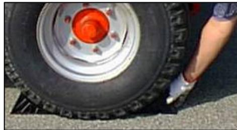
Esempio di posizionamento cunei di blocco
