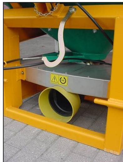
*Esempio di albero cardanico protetto e dotato di supporto*
