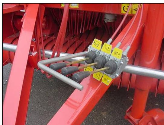
*Esempio di comandi con dispositivo anti-azionamento involontario*
