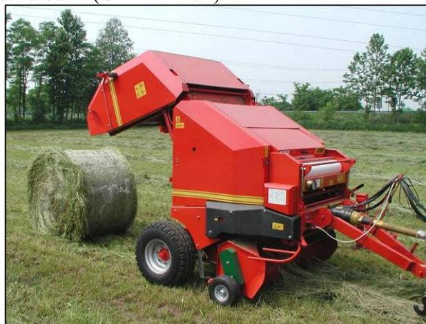
*Esempio di portellone di espulsione della balla*
