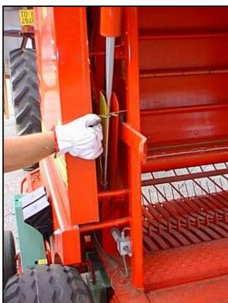
*Esempio di blocco meccanico di supporto*
