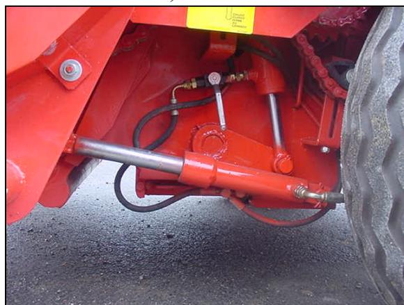
*Esempio di blocco idraulico sul martinetto*
