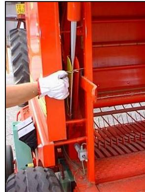
*Esempio di dispositivo di blocco meccanico*
