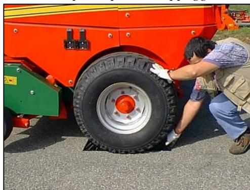
*Esempio di posizionamento cunei di blocco*
