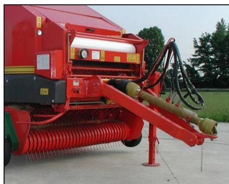
*Esempio di albero cardanico protetto e dotato di supporto*
