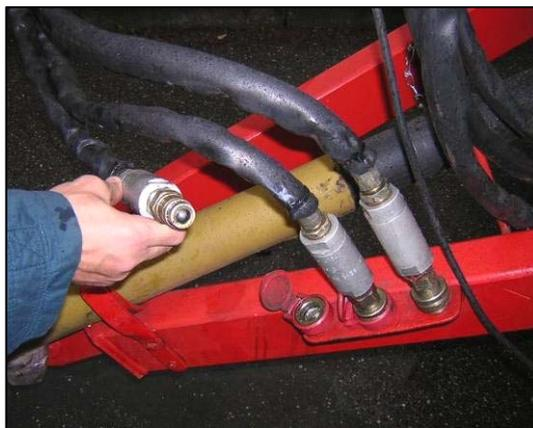
*Esempio di supporto tubi idraulici e guaine antiscoppio*
