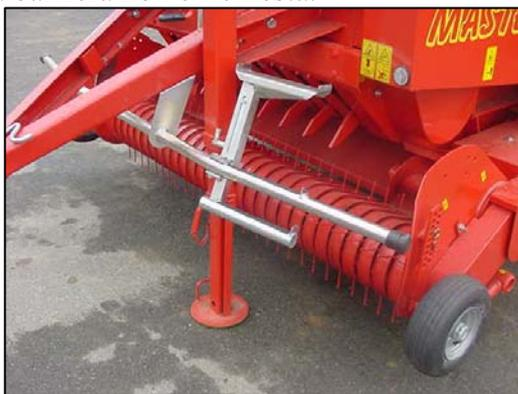
*Esempio di dispositivo di raccolta con ripari laterali e barriera frontale*
