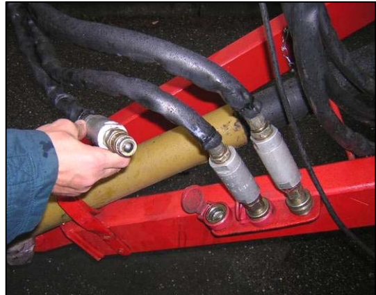
Esempio di supporto tubi idraulici e guaine antiscoppio
