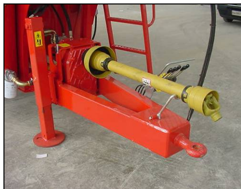
Esempio di albero cardanico protetto e dotato di supporto
