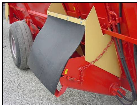
Esempio di scarico a nastro coperto
