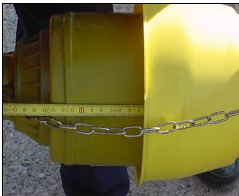
Quota minima di sovrapposizione (UNI EN ISO 4254-1)
