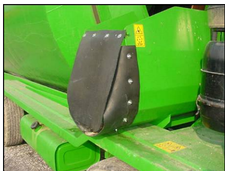
Esempio di scarico a coclea coperto
