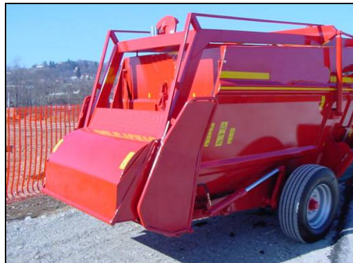
Esempio di protezione frontale della fresa
