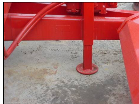
Esempio di piede di appoggio
