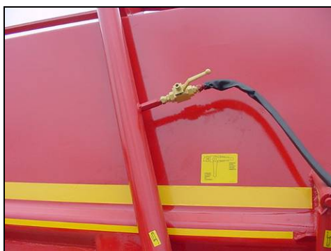
Esempio di dispositivo di bloccaggio idraulico
