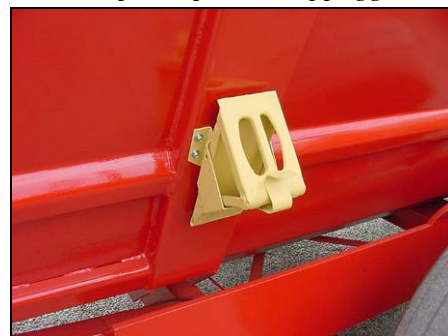
Esempio di alloggiamento cunei di blocco
