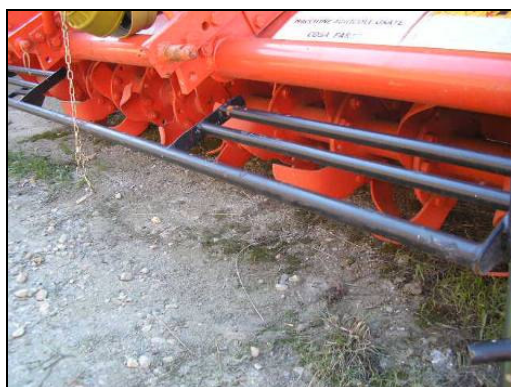
Esempio di protezione anteriore
