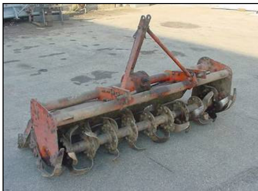
Esempio di fresatrice agricola senza barriere
