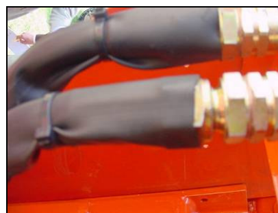
Esempio di supporto tubi idraulici con guaine antiscoppio
