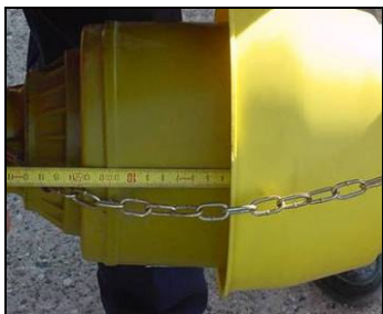
Quota minima di sovrapposizione (UNI EN ISO 4254-1)
