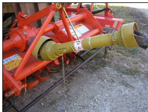
Esempio di albero cardanico protetto e dotato di supporto
