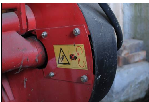
Esempio di riparo chiuso mediante bulloni
