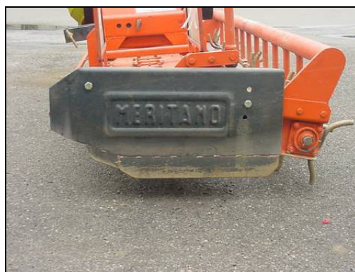
Esempio di protezione laterale con a < 200 mm
