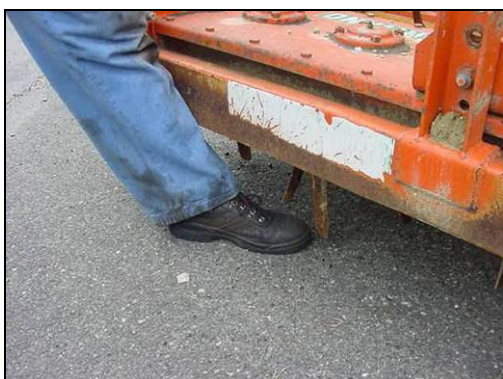
Esempio di erpice rotativo senza barriere
