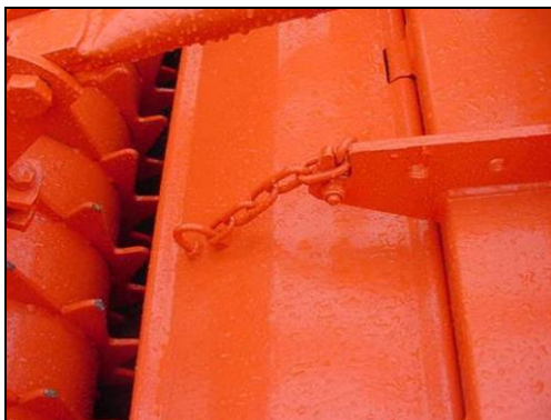
Esempio di protezione posteriore incernierata
