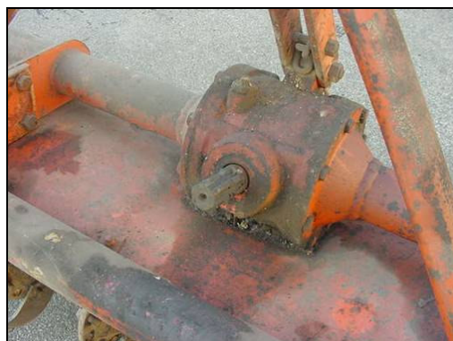
Esempio di trasmissione cardanica priva di protezioni
