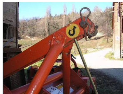
Indicazione del punto di sollevamento di una fresatrice agricola
