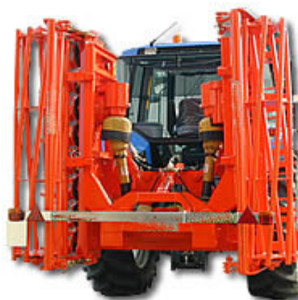
Esempio di erpice rotativo ripiegato in fase di trasporto su strada
