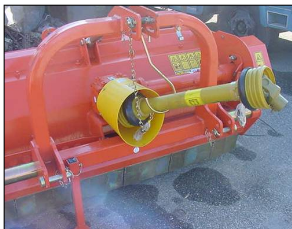
Sistema di trasmissione del moto modificato con albero cardanico protetto, cuffia conforme, supporto a riposo dell'albero e catenelle antirotazione
