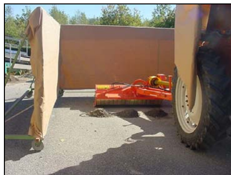
Macchina e materiale di prova all'interno della camera di lancio
