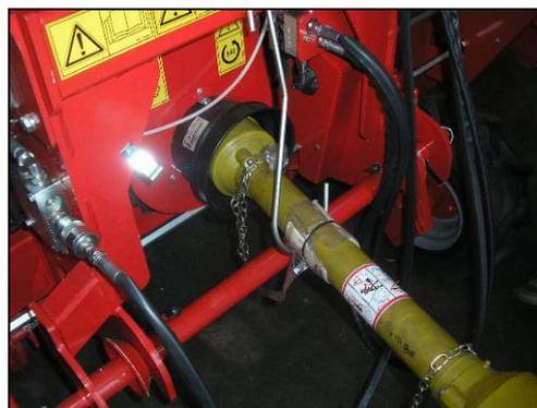
*Esempio di trasmissione cardanica protetta*
