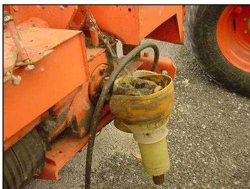
*Esempio di trasmissione cardanica non protetta*
