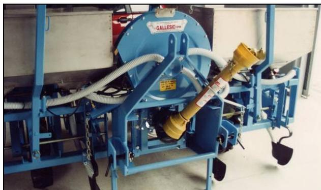
*Sistema di trasmissione del moto con albero cardanico protetto, cuffia conforme e supporto a riposo dell'albero*
