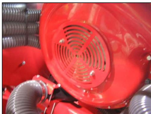
*Esempio di ventilatore protetto mediante riparo fisso*
