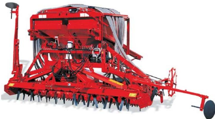
*Esempio di seminatrice con dispositivo marcafile ripiegabile e regolabile*
