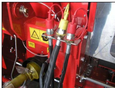
*Supporto tubi idraulici*
