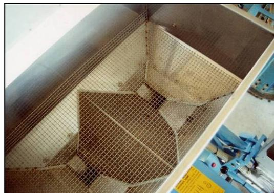
*Esempio di dispositivo di chiusura della tramoggia      Esempio di dispositivo di protezione della tramoggia*
