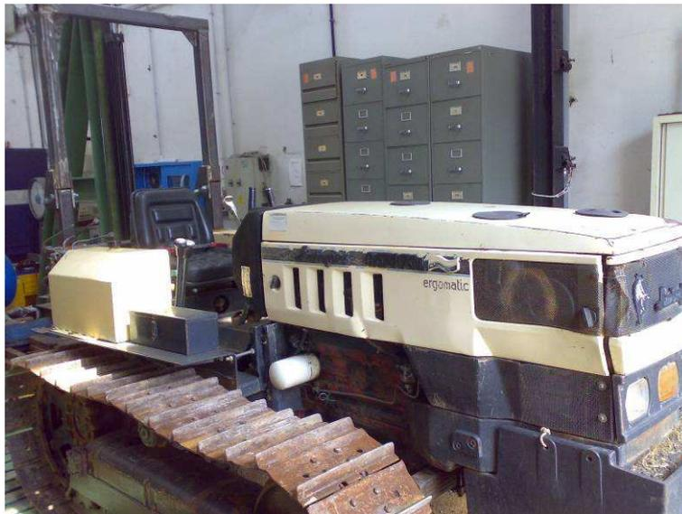
Figura 12. Struttura di protezione per trattori a cingoli modello Lamborghini C674 e simili
