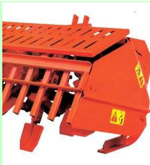
Esempio di protezione laterale
