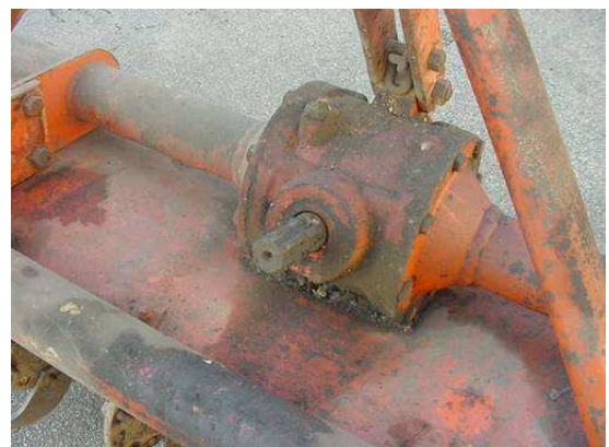
Esempio di trasmissione cardanica priva di protezioni
