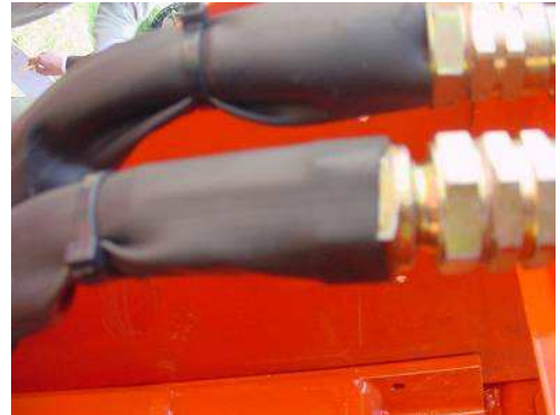
Esempio di supporto tubi idraulici con guaine antiscoppio
