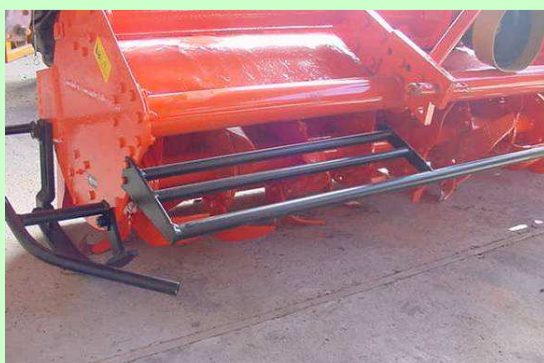
Esempio di barriera di protezione
