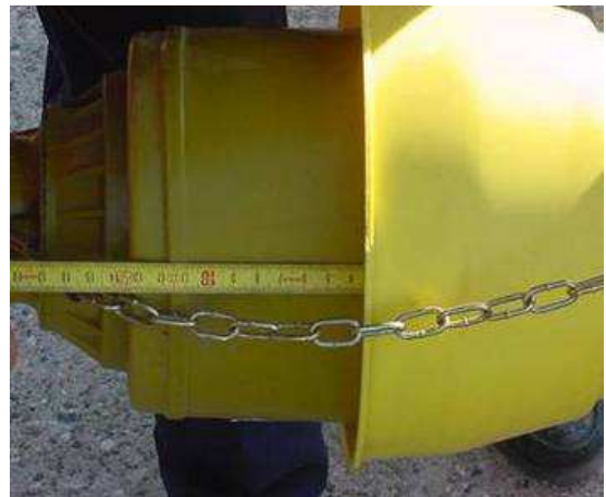
Quota minima di sovrapposizione (UNI EN ISO 4254-1)
