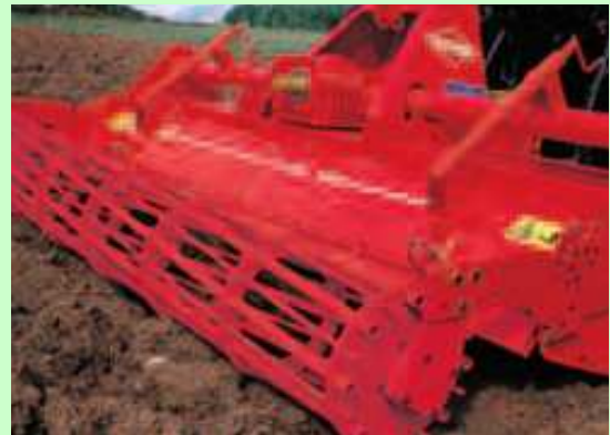
Esempio di fresatrice con rullo posteriore
