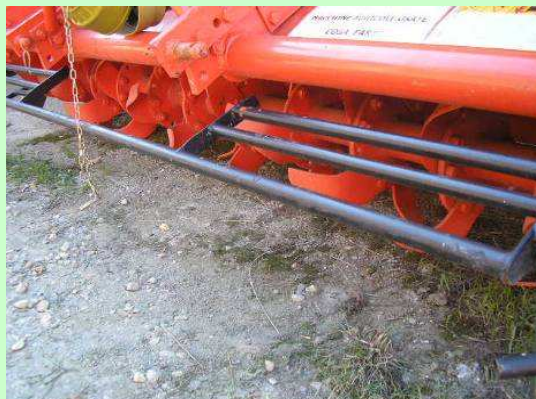
Esempio di protezione anteriore
