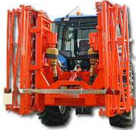
Esempio di erpice rotativo ripiegato in fase di trasporto su strada
