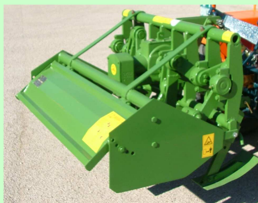
Esempio di cofano di protezione posteriore
