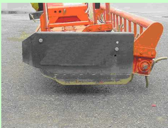
Esempio di protezione laterale con a < 200 mm
