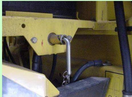
Esempio di dispositivo stacca-batteria
