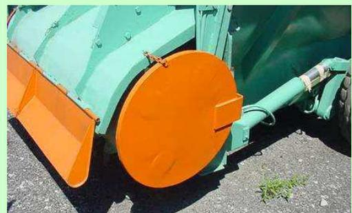
*Dispositivo di protezione laterale*
