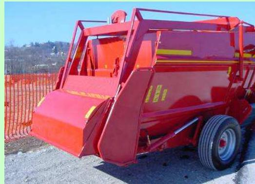
*Esempio di protezione frontale della fresa*
