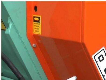
*Esempio di trasmissione protetta con carter fisso*
