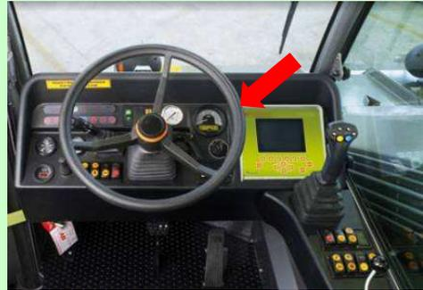
*Esempio di ubicazione del visualizzatore del sistema di pesatura*
