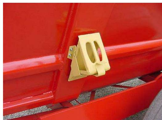
*Esempio di alloggiamento cunei di blocco*
