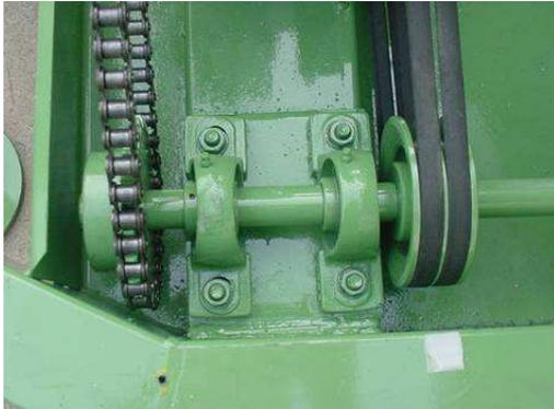
*Esempio di trasmissione non protetta*
