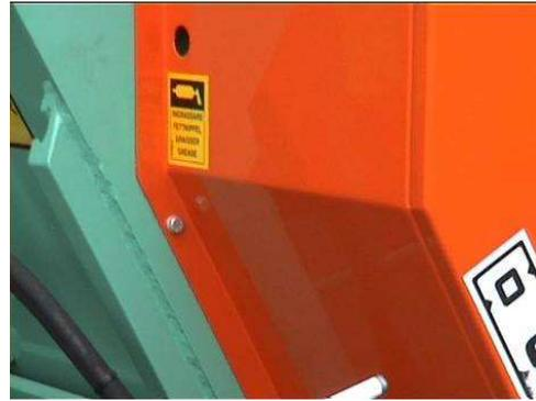
*Esempio di trasmissione protetta con carter fisso*
