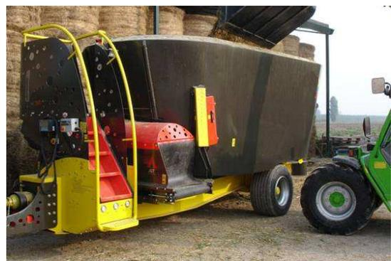
*Esempi di scala di accesso per il controllo della miscelazione e/o l'aggiunta di componenti*
