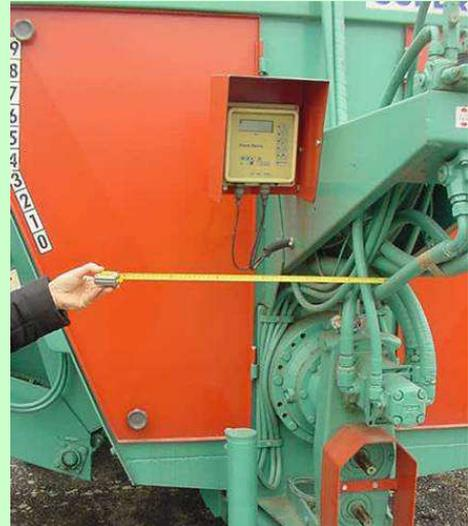
*Esempio di ubicazione del visualizzatore del sistema di pesatura*
