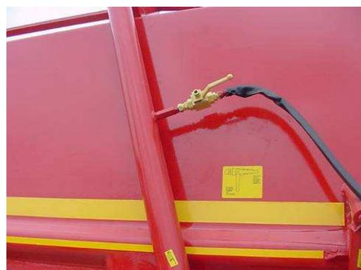
*Esempio di dispositivo di bloccaggio idraulico*
