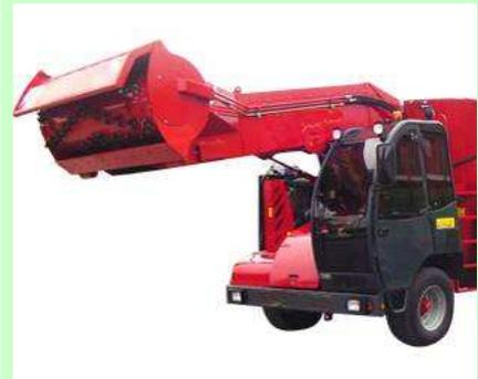
*Esempio di utensili di taglio e di carico: fresa desilatrice*
