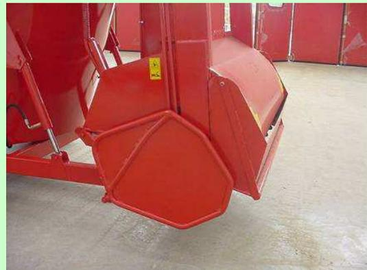
*Esempio di dispositivo di protezione laterale*
