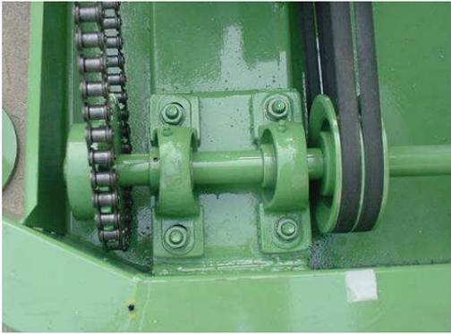
*Esempio di trasmissione non protetta*
