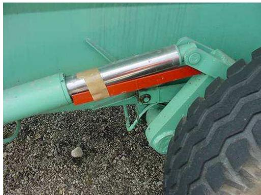
*Esempio di dispositivo di bloccaggio meccanico*
