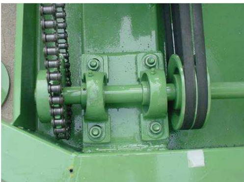
*Esempio di trasmissione non protetta*
