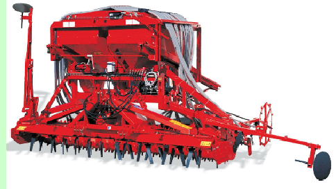
Esempio di seminatrice con dispositivo marcafile ripiegabile e regolabile
