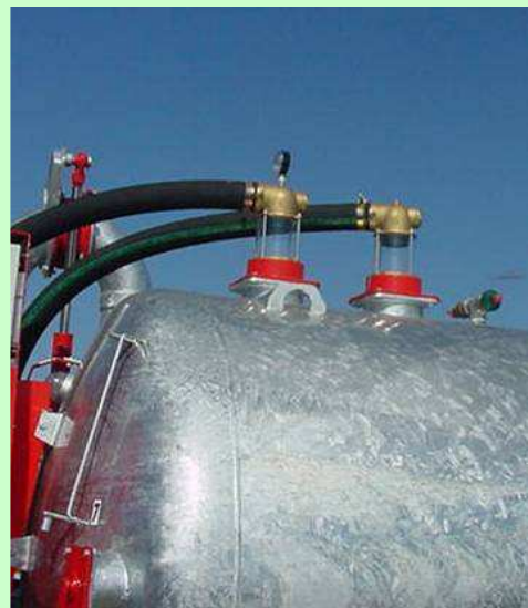
Esempio di dispositivo di troppo pieno
