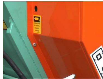
Esempio di riparo chiuso mediante bulloni
