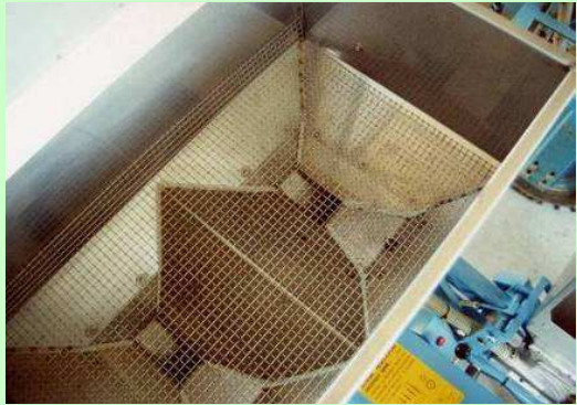
Esempio di griglia di protezione della tramoggia
