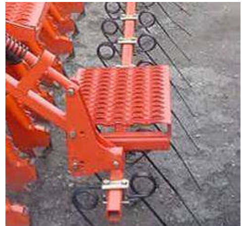
Esempio di superficie antisdrucciolevole
