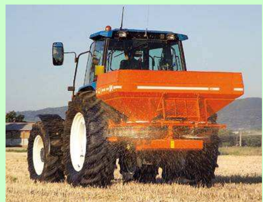
Esempio di spandiconcime portato applicato alla trattrice
