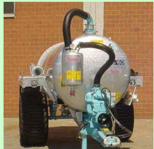
Esempio di supporto tubi flessibili al serbatoio
