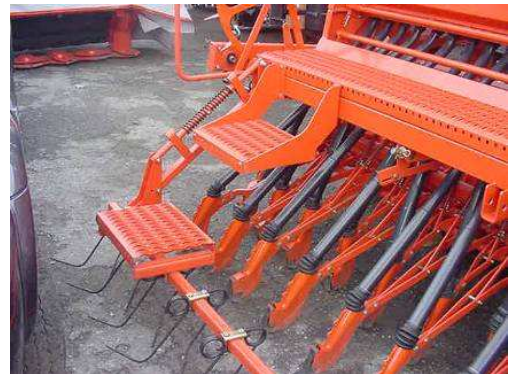
Esempio di scaletta di accesso
