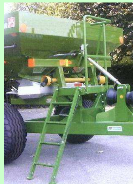
Esempi di mezzi di accesso alla tramoggia
