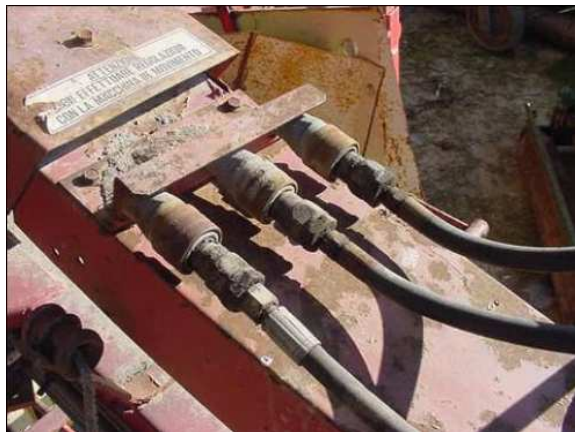
Esempio di tubi idraulici non protetti
