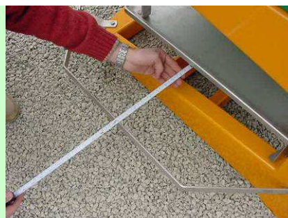
Esempio di barriere di protezione degli organi spanditori
