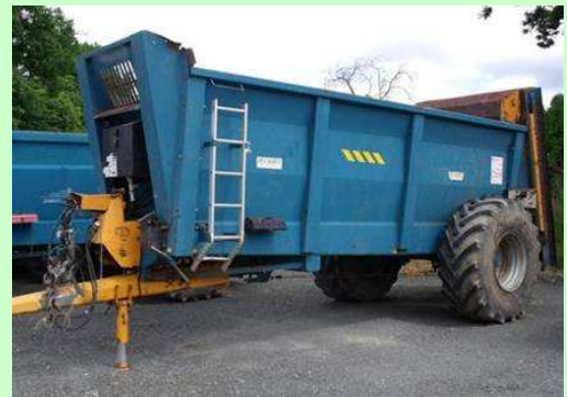
Esempio di scala di accesso al cassone
