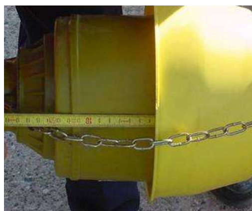
Quota minima di sovrapposizione (UNI EN ISO 4254-1)
