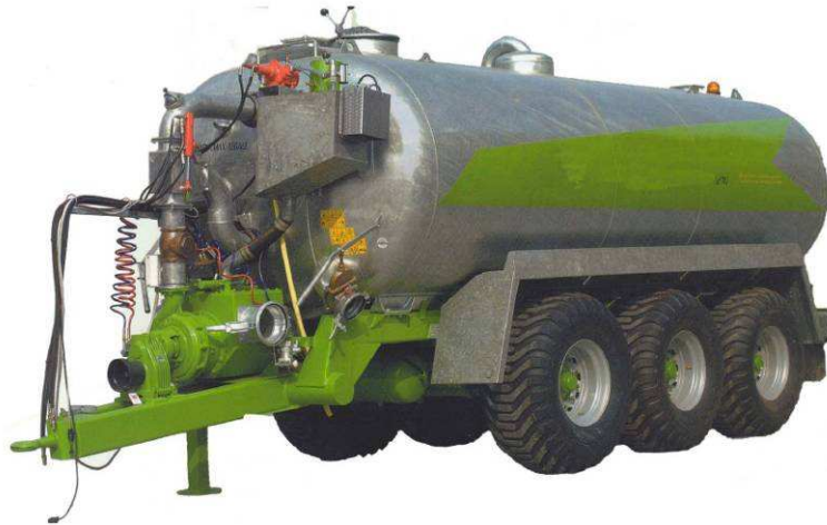
Esempio di spandiliquame con serbatoio in pressione, ad azionamento pneumatico
