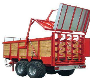
Esempio di organi spanditori con protezione contro il contatto involontario
