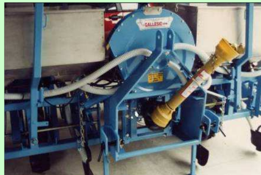
Esempio di zona di accoppiamento alla trattrice della seminatrice
