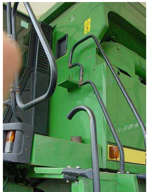
Esempi di scaletta con mancorrenti
