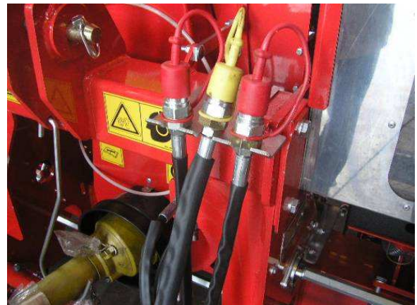
Esempio di tubi idraulici protetti e supportati
