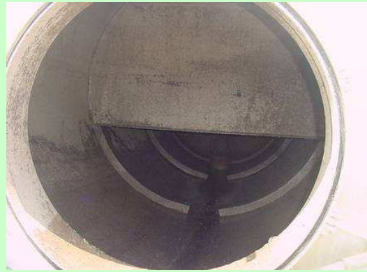
Esempio di diaframma anti-sbattimento
