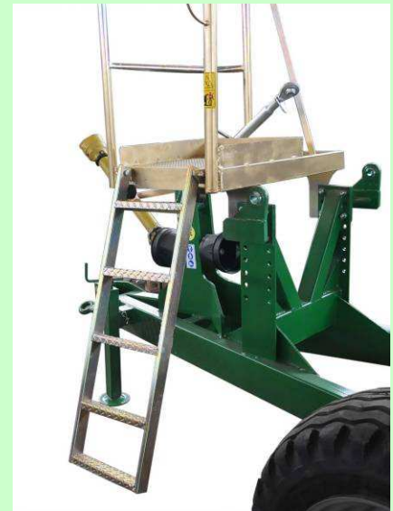
Esempi di mezzi di accesso alla tramoggia
