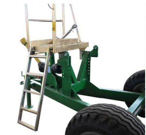
Esempio di scaletta di accesso
