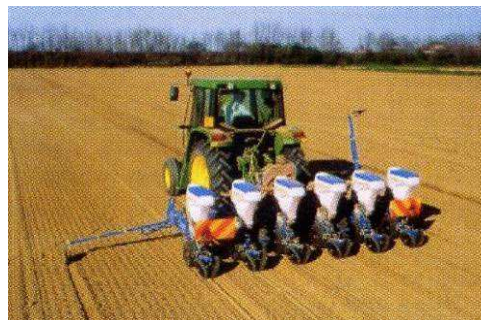
Esempio di seminatrice di precisione semiportata
