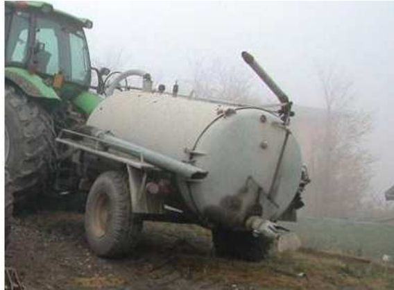
Esempio di spandiliquame con serbatoio a pressione atmosferica, ad azionamento meccanico
