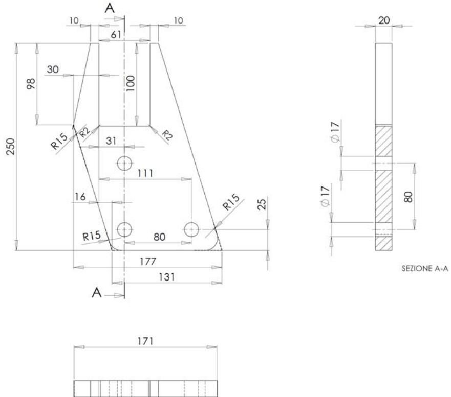
Figura 2. Piastra interna di collegamento per telaio abbattibile
