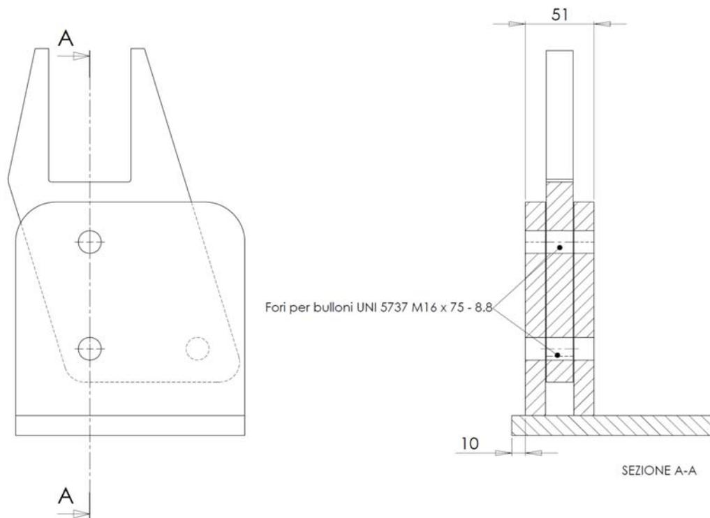
**Figura 4. Assieme dell'elemento di collegamento per telaio abbattibile**
