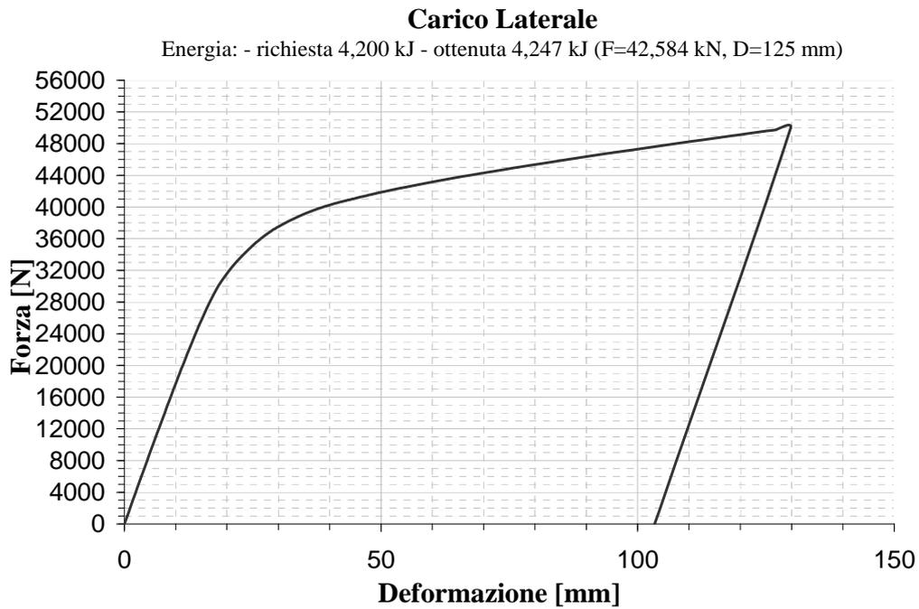
Figura 9. Carico laterale: diagramma Forza vs. Deformazione
