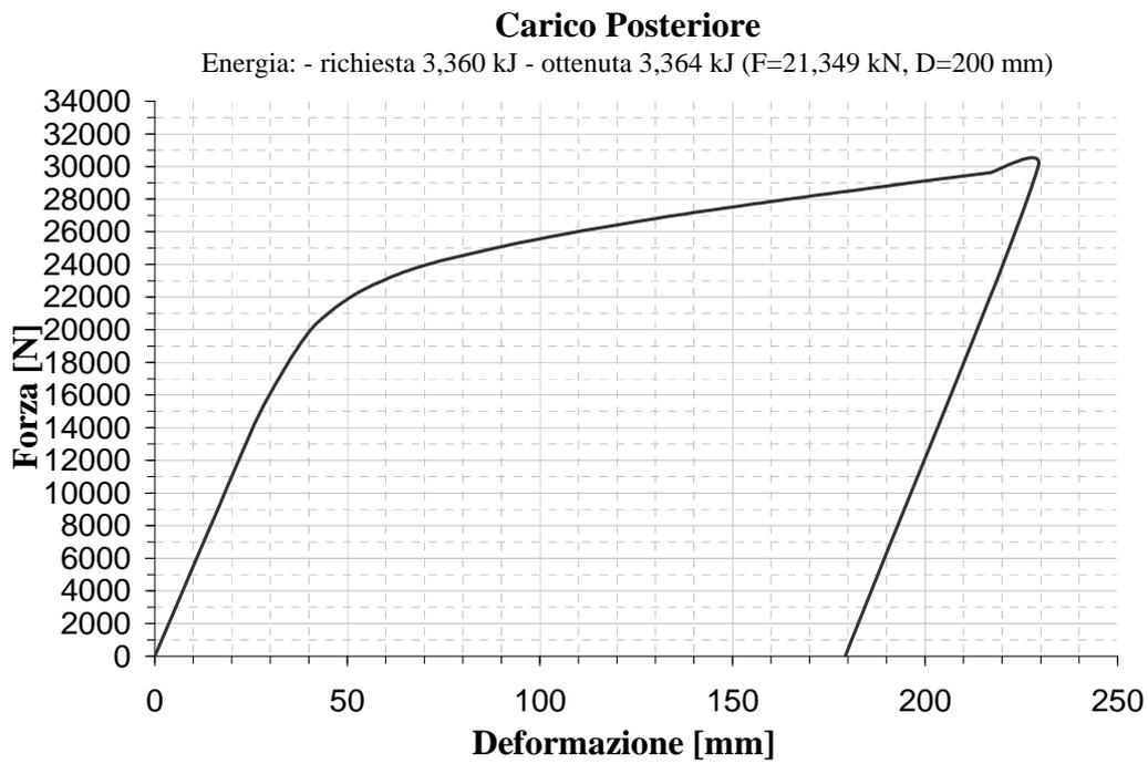
Figura 7. Carico posteriore: diagramma Forza vs. Deformazione
