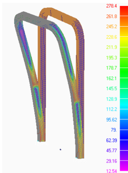
Figura 5. Carico posteriore: diagramma a falsi colori della tensione [MPa]
