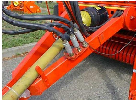
*Esempio di tubi idraulici dotati di guaina antiscoppio e correttamente supportati*
