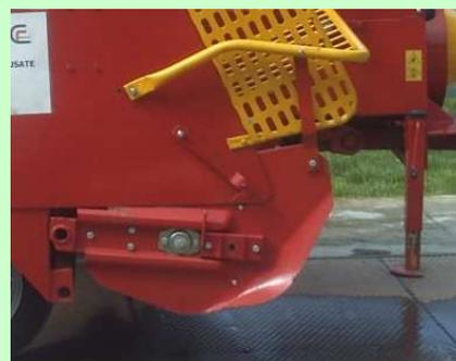
*Esempio di protezione laterale del pick-up*
