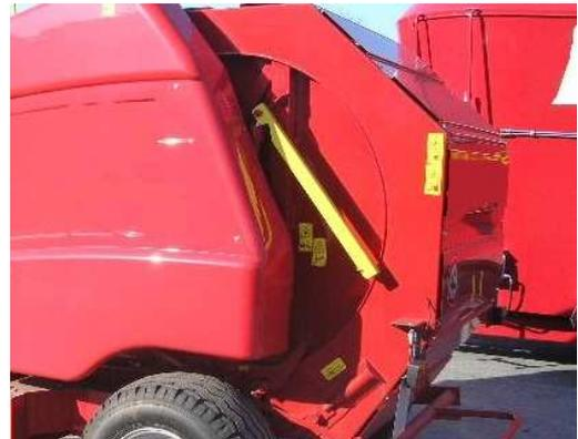
*Esempio di dispositivo di bloccaggio meccanico*
