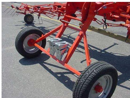
*Esempio di spandivoltafieno con cunei di blocco alloggiati sulla macchina*
