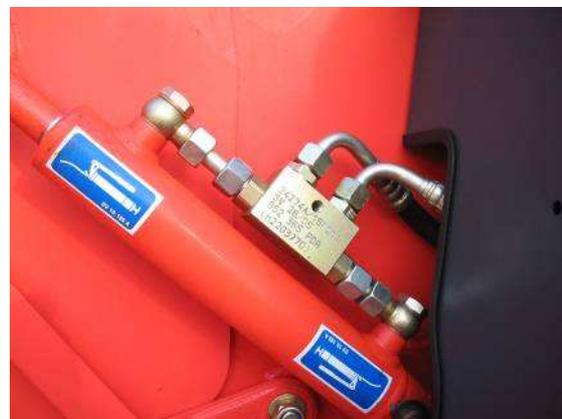
*Esempio di valvola di blocco idraulica*
