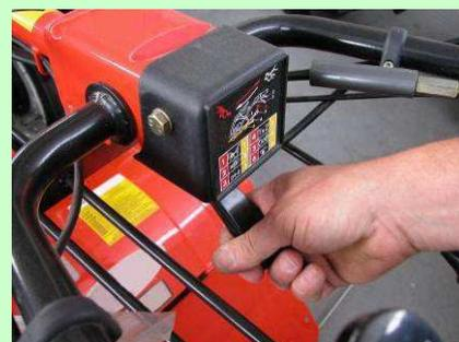
*Esempio di dispositivo di bloccaggio delle stegole*
