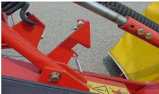
*Esempio di dispositivo di blocco meccanico*
