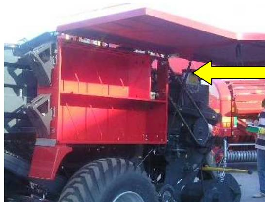
*Esempio di martinetto idraulico per elementi sollevabili*
