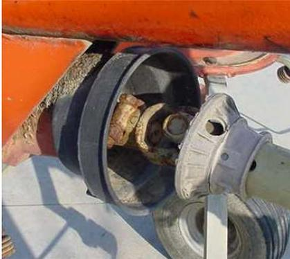
*Esempio di trasmissione cardanica non adeguatamente protetta*
