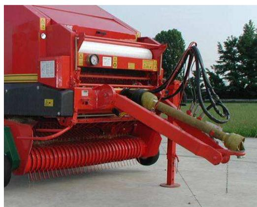
*Esempio di trasmissione cardanica protetta e supportata*
