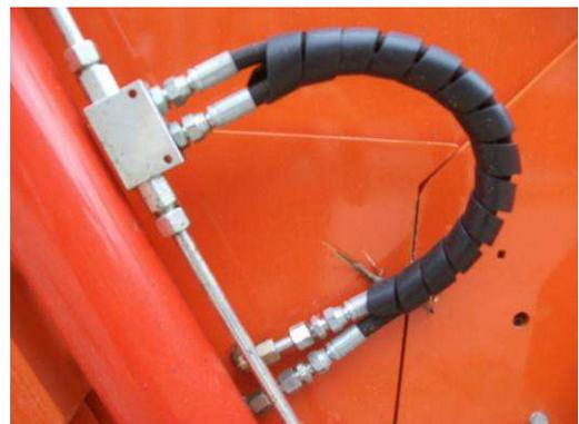
*Esempio di dispositivo di bloccaggio idraulico*
