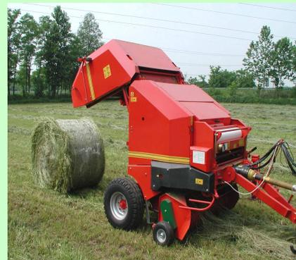
*Esempio di espulsore della balla adeguatamente protetto*
