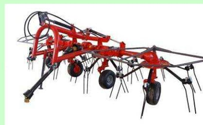
*Esempio di spandivoltafieno ripiegabile idraulicamente*
