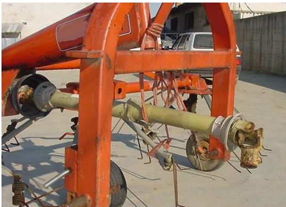
*Esempio di trasmissione cardanica non adeguatamente protetta*
