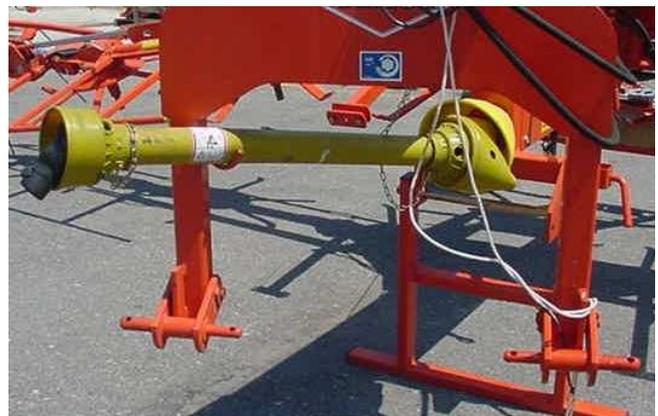
*Esempio di trasmissione cardanica adeguatamente protetta*
