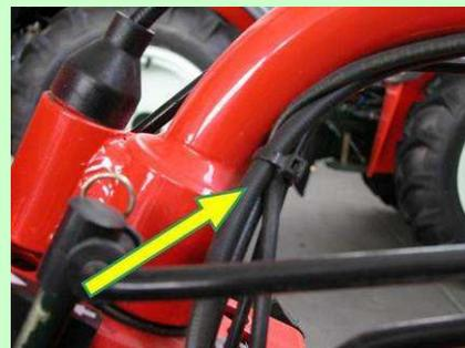
*Esempio di fissaggio e raggruppamento dei cavi elettrici*
