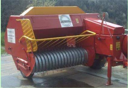
*Esempio di sistema di alimentazione dotato di protezioni idonee*
