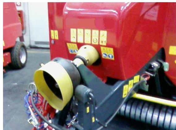
*Esempio di trasmissione cardanica protetta*
