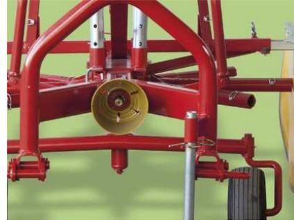
*Esempio di trasmissione cardanica adeguatamente protetta*
