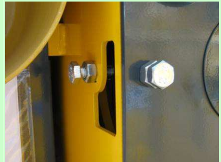
Esempio di protezione mediante carter imbullonato
