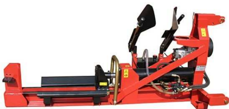
Esempio di spaccalegna orizzontale a cardano
