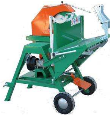
Esempio di segatrice a cardano
