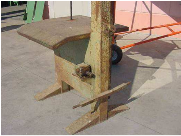
Esempio di segatrice a nastro priva di protezioni
