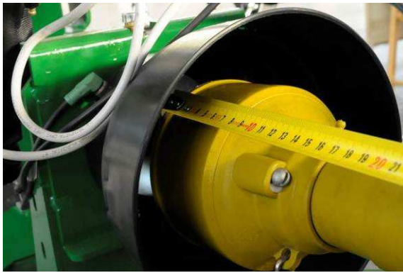
Esempi di collegamento alla presa di potenza adeguatamente protetti
