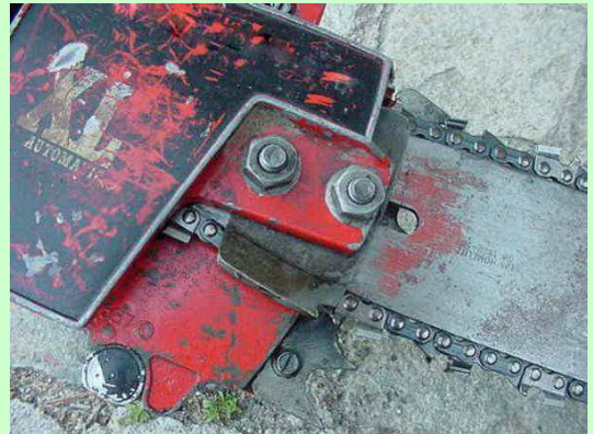
Esempio di direzione di tendicatena manuale
