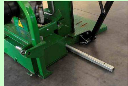
Esempio di dispositivo per garantire la stabilità della macchina
