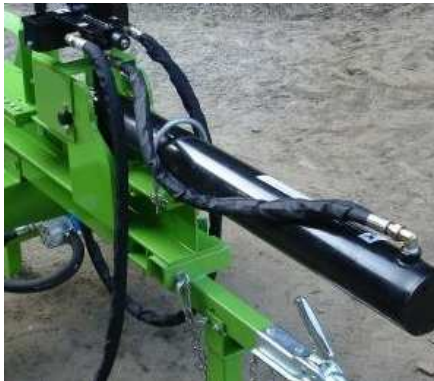
Esempi di linee idrauliche protette con guaine antiscoppio
