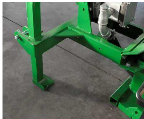
Esempio di piede stabilizzatore
