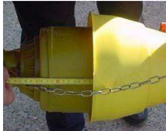
Quota minima di sovrapposizione (UNI EN ISO 4254-1)
