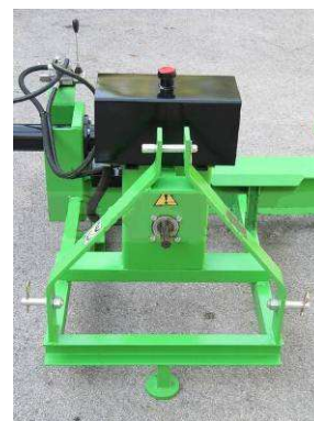
Esempio di presa di potenza priva di protezioni adeguate
