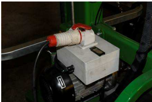
Esempio di impianto elettrico adeguatamente protetto
