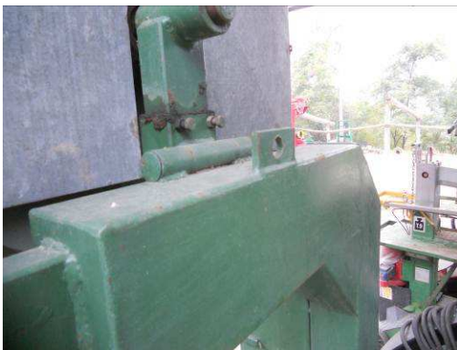
Esempi di asole per il sollevamento della macchina
