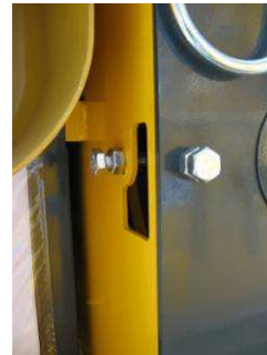
Esempio di riparo chiuso mediante bulloni
