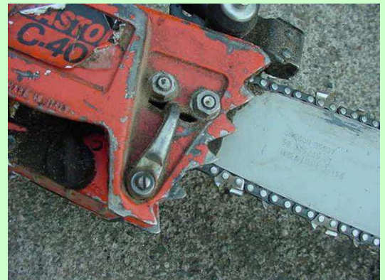
Esempio di tendicatena automatica
