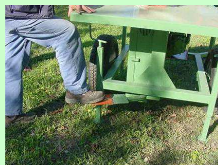
Esempio di comando di arresto a pedale
