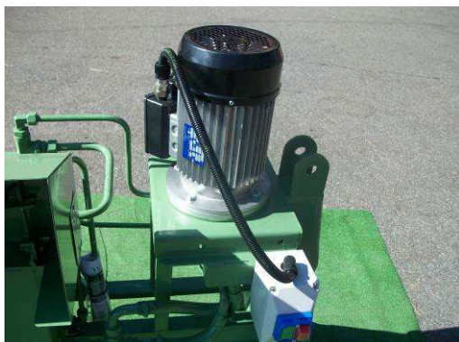
Esempi di impianto elettrico adeguatamente protetto
