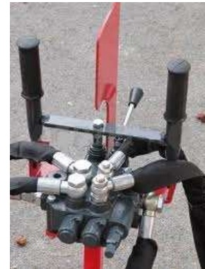
Esempi di linee idrauliche protette con guaine antiscoppio
