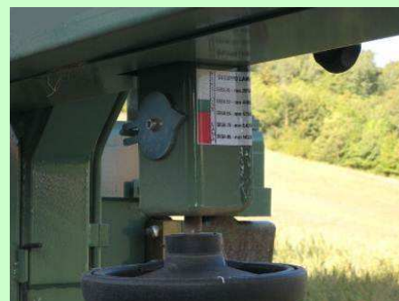
Esempio di regolatore della tensione della lama
