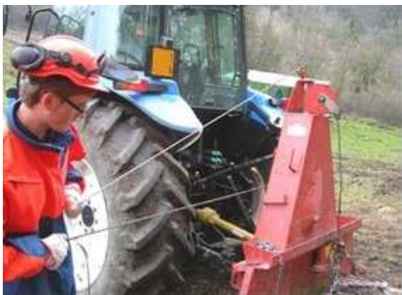
Esempio di verricello montato su trattrice e comandato mediante funi di rinvio
