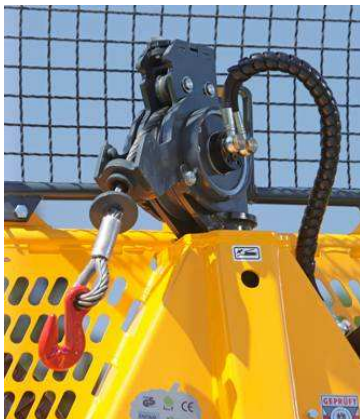
Esempio di tubi idraulici protetti da una guaina
