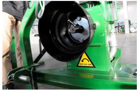
Esempi di collegamento alla presa di potenza adeguatamente protetti
