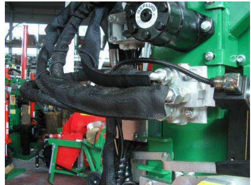
Tubi idraulici con guaine antiscoppio
