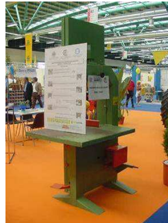
Esempio di segatrice a nastro usata adeguata ai requisiti di sicurezza
