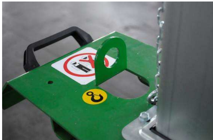
Esempio di indicazione del punto di sollevamento della macchina
