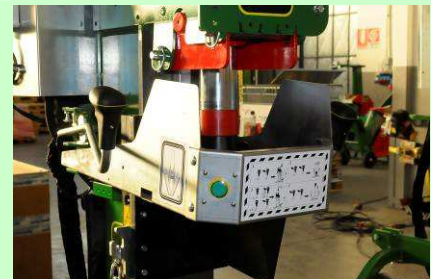
Esempio di dispositivo di arresto a barra sensibile
