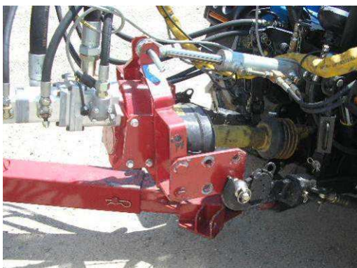
Esempio di trasmissione cardanica dotata di protezioni adeguate
