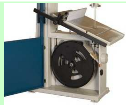
Esempio di volano comandato dotato di freno
