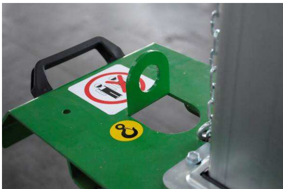
Esempi di punti di sollevamento correttamente indicati
