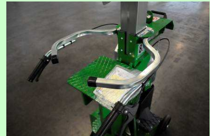
Esempio di comandi a due mani ad azione mantenuta
