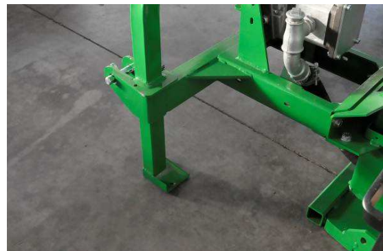
Esempio di spaccalegna correttamente supportato
