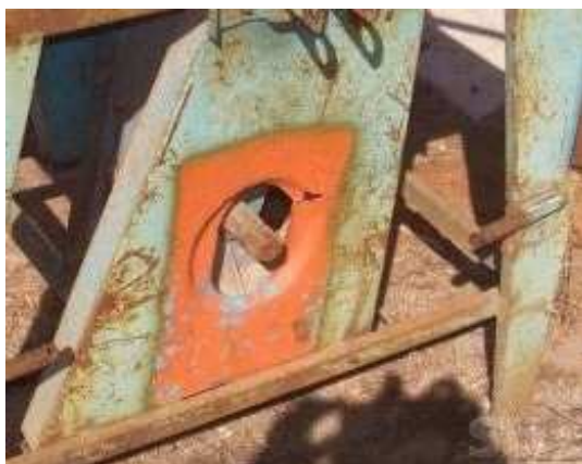
Esempio di presa di potenza non protetta
