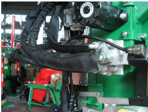
Esempi di linee idrauliche protette con guaine antiscoppio
