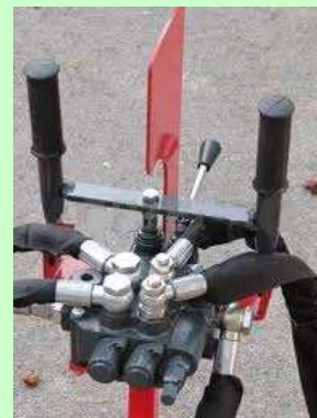
Esempio di comandi a due mani ad azione mantenuta
