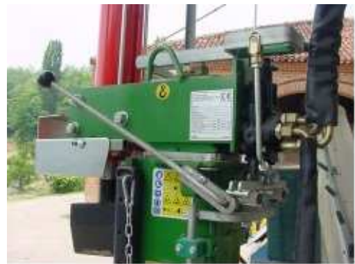
Esempi di punti di sollevamento correttamente indicati
