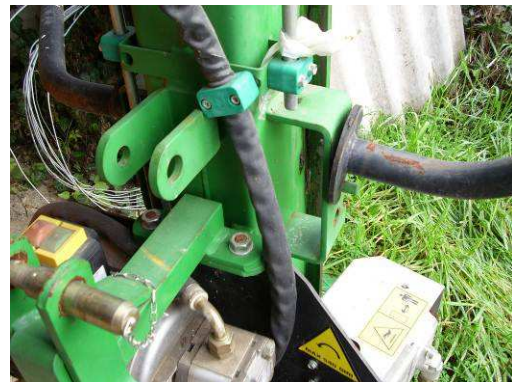
Esempi di linee idrauliche protette con guaine antiscoppio
