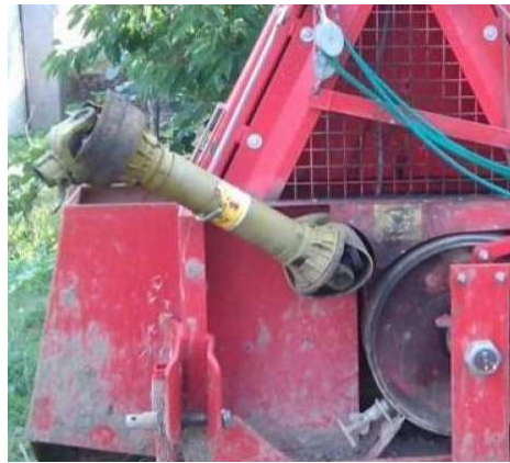
Esempio di trasmissione cardanica non adeguatamente protetta
