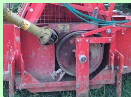
Esempio di freno a nastro
