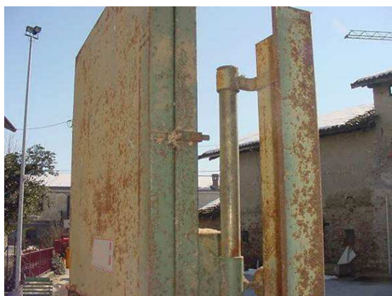
Esempio di carter apribile senza l'ausilio di utensili
