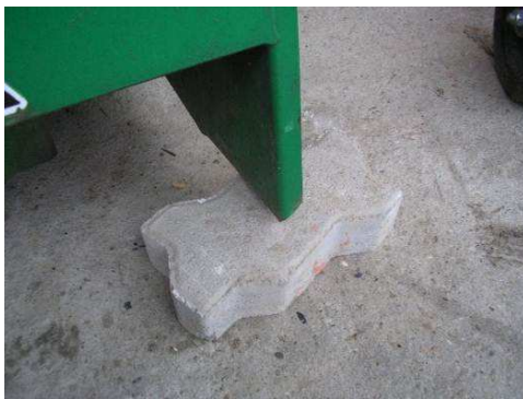
Esempio di spaccalegna con supporto rudimentale
