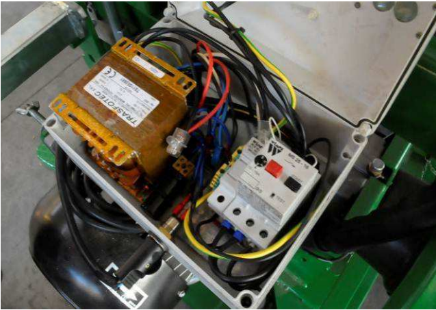
Esempio di fissaggio e raggruppamento di fili elettrici
