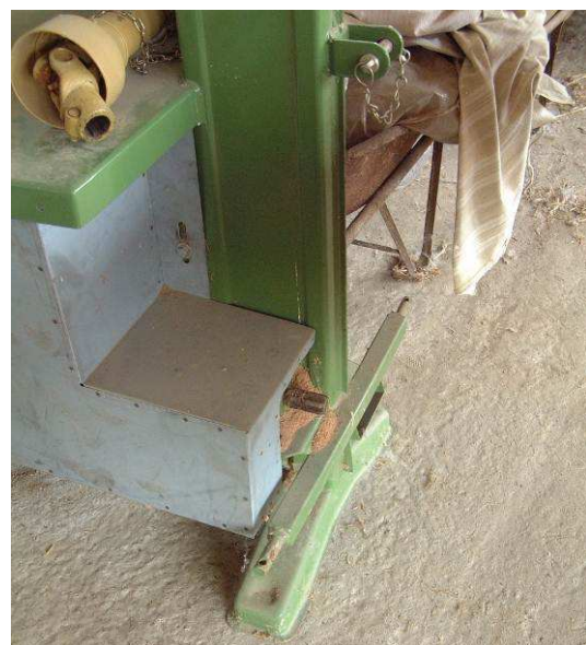
Esempio di trasmissione cardanica priva di protezioni
