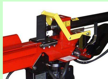
Esempio di dispositivo di arresto a barra sensibile
