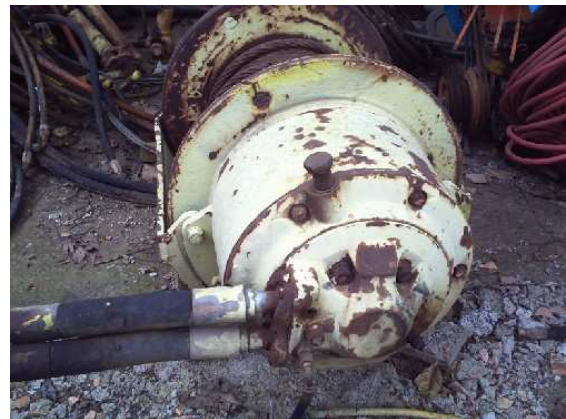
Esempio di tubi idraulici privi di adeguata protezione
