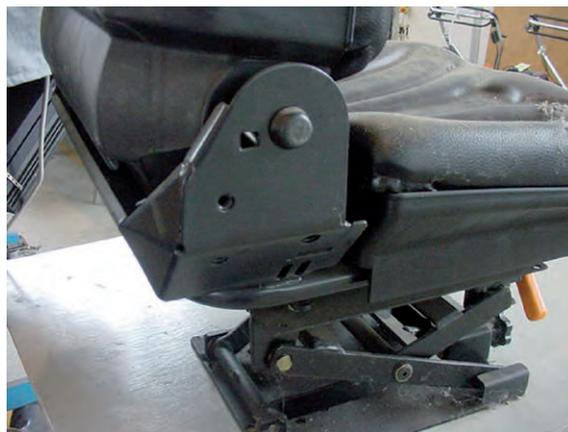
Se non predisposto, è pertanto necessario sostituire il sedile con un altro provvisto di cinture o di altro idoneo sistema di ritenzione del conducente, che garantisca la solidità e gli spazi di manovra del sedile originale. La sostituzione del sedile deve essere effettuata secondo le "Linee Guida INAIL" da persona competente, che rilasci "Certificato di Installazione".
