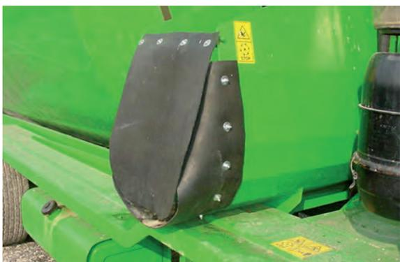
Esempio di protezione tappeto di scarico
