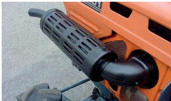
E' necessario inoltre, proteggere nello stesso modo anche le ulteriori parti calde (collettore e marmitta) che, in fase di lavoro, possono raggiungere temperature superiori a 80° C e che si trovino al di fuori della zona in figura, per esempio qualora la trattrice sia utilizzata in posizione fissa come sorgente di potenza.
