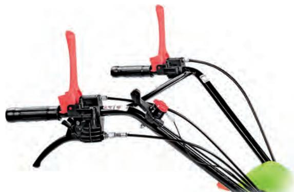
Le "Linee Guida INAIL" prescrivono inoltre di tenere in considerazione aspetti ergonomici legati allo sforzo richiesto alla mano dell'operatore per mantenere azionato il comando ad azione mantenuta, anche allo scopo di prevenire manomissioni.
