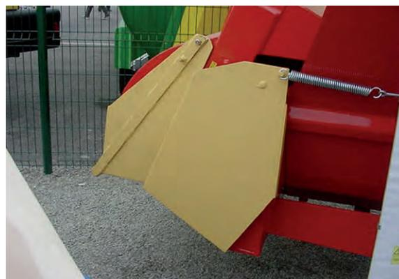
Esempio di protezione fresa desilatrice
