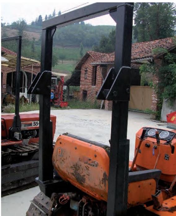
Esempio di telaio posteriore abbattibile
