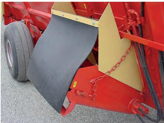
Esempio di protezione tappeto di scarico
