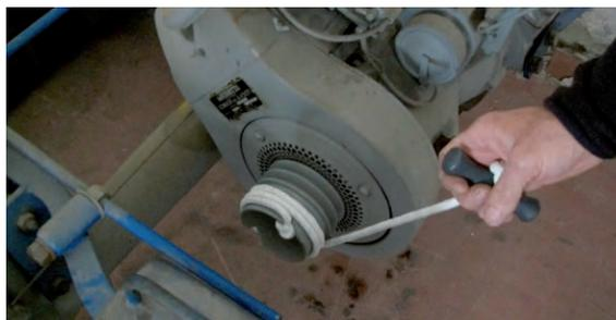
Nel caso di motori diesel è consentito l'utilizzo della fune persa ma il volano deve essere protetto da un carter che si deve poter aprire mediante utensile e che si deve chiudere senza utensile.
