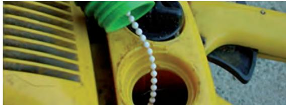
Esempio di dispositivo di tenuta del tappo
