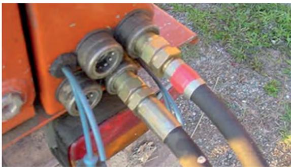
Adozione di un codice di riconoscimento delle prese olio
