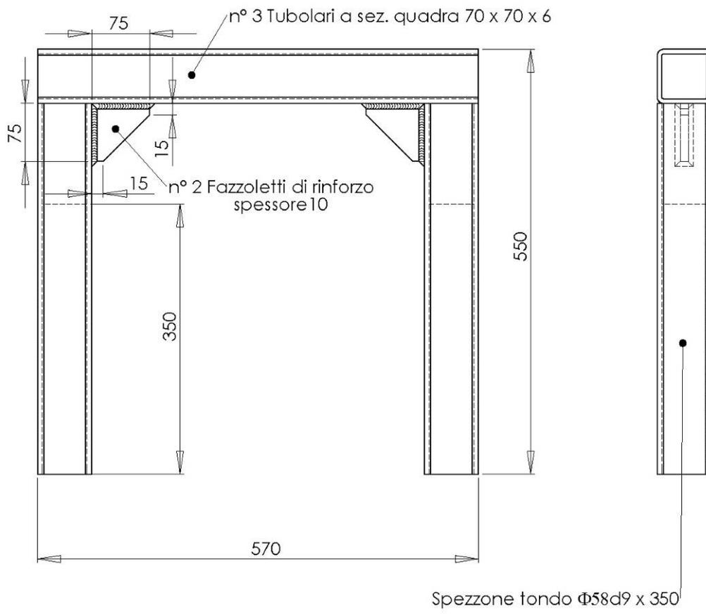
Figura 1. Telaio rigido posteriore
