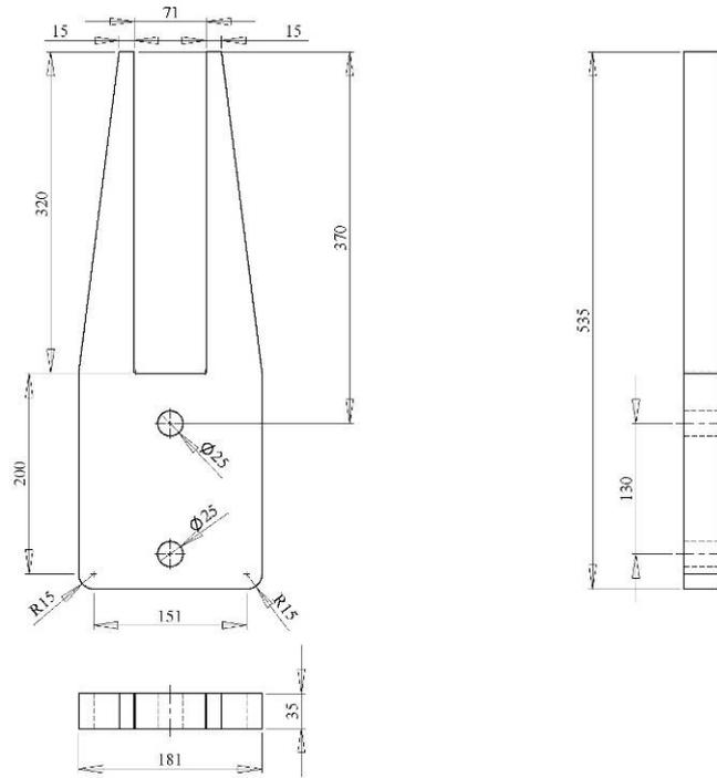
Figura 3. Piastra interna di collegamento per telaio fisso
