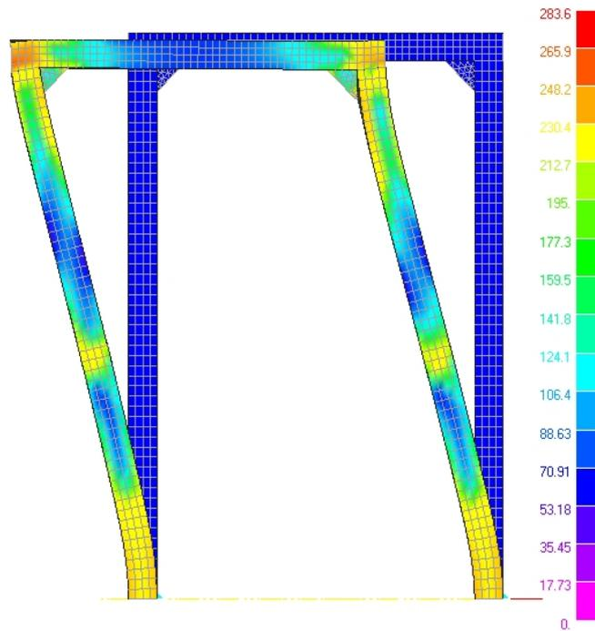
Figura 9. Carico laterale: diagramma a falsi colori della tensione [MPa]
