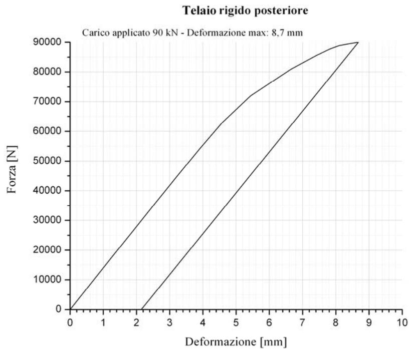
Figura 15. Telaio rigido posteriore: diagramma Forza vs. Deformazione
