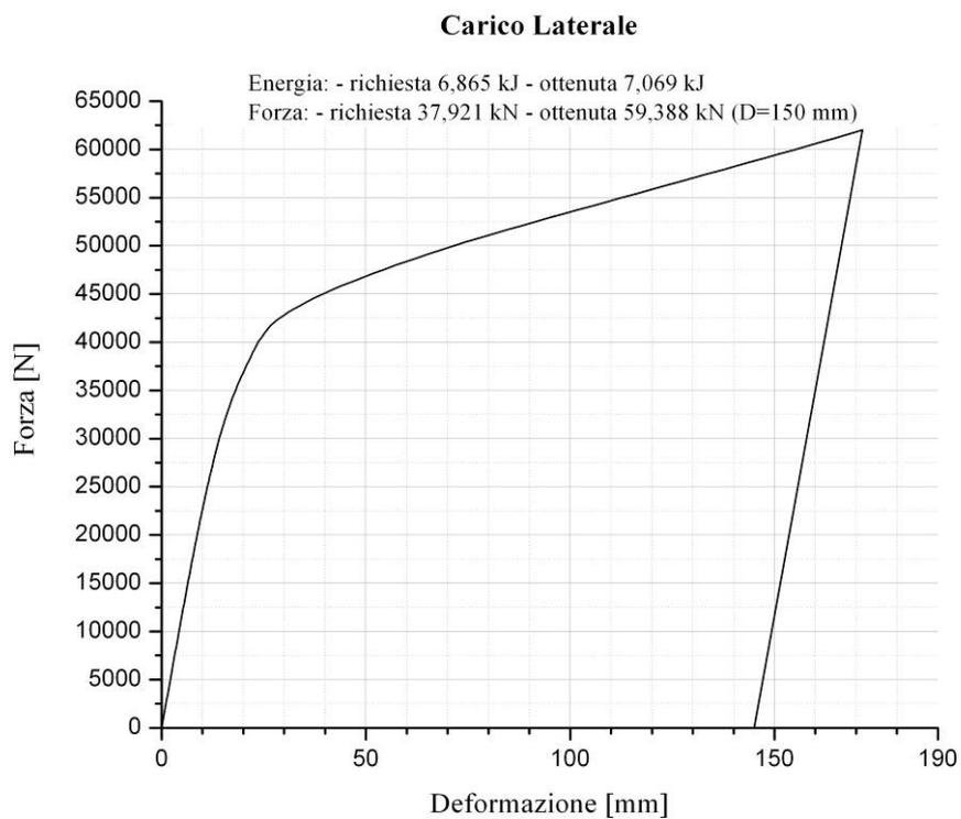
Figura 10. Carico laterale: diagramma Forza vs. Deformazione
