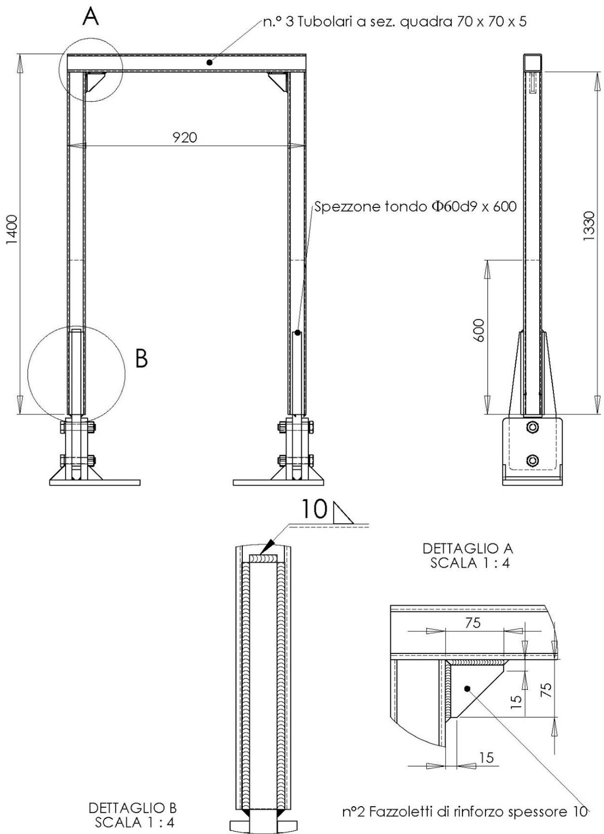
Figura 2. Telaio di protezione anteriore fisso
