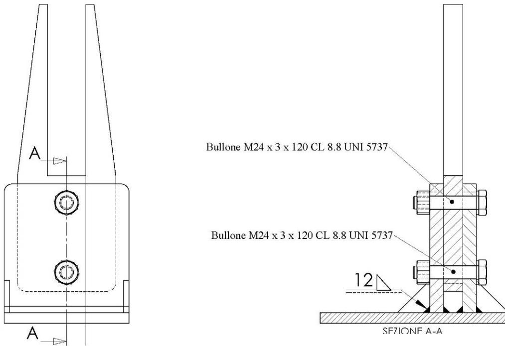
Figura 5. Assieme dell'elemento di collegamento per telaio fisso
