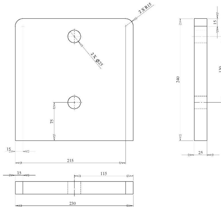
Figura 4. Piastra laterale interna per telaio fisso
