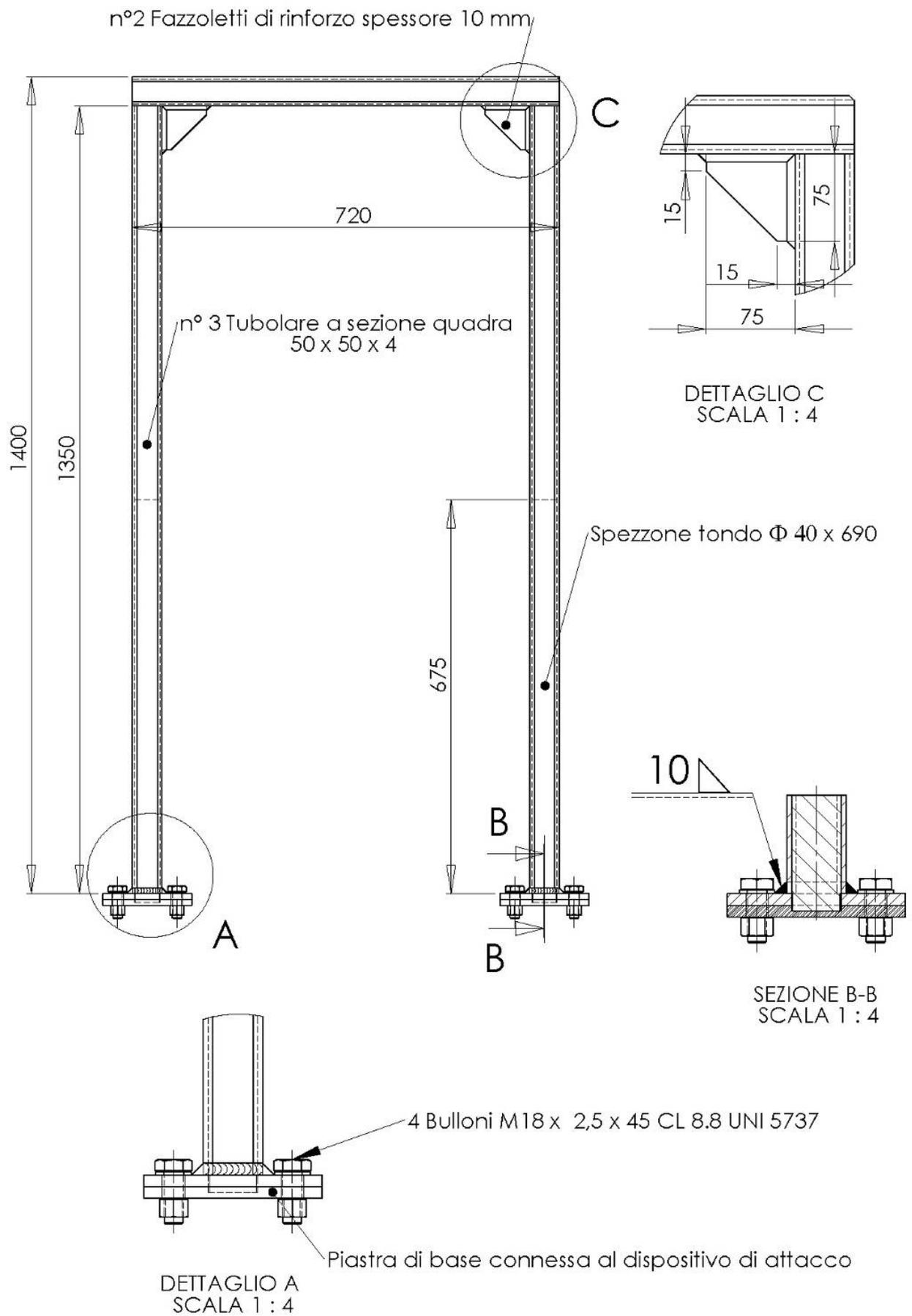
Figura 1. Telaio di protezione posteriore fisso
