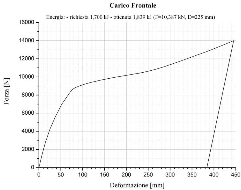
Figura 8. Carico frontale: diagramma Forza vs. Deformazione
