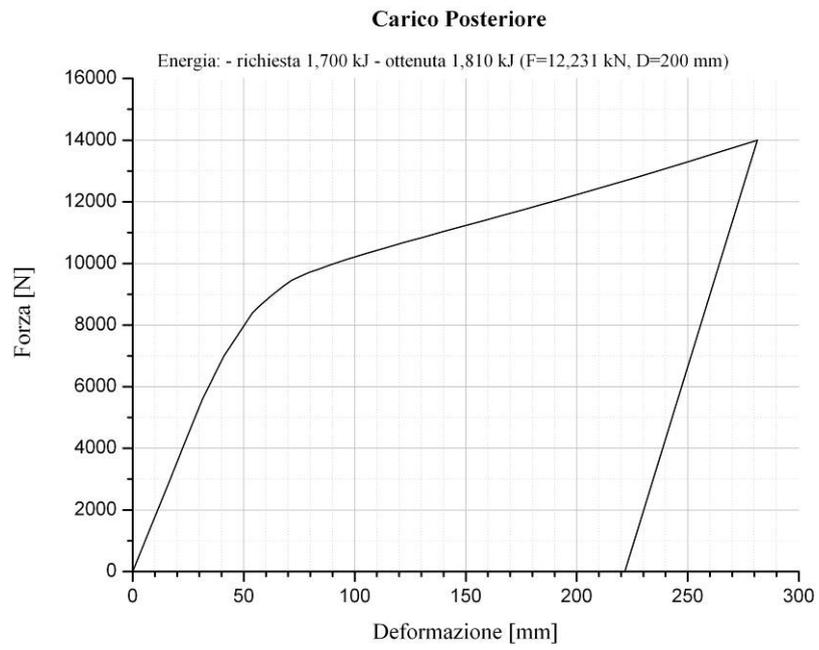
Figura 6. Carico posteriore: diagramma Forza vs. Deformazione
