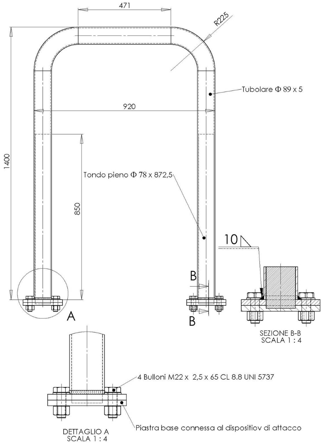
Figura 1. Telaio di protezione posteriore fisso
