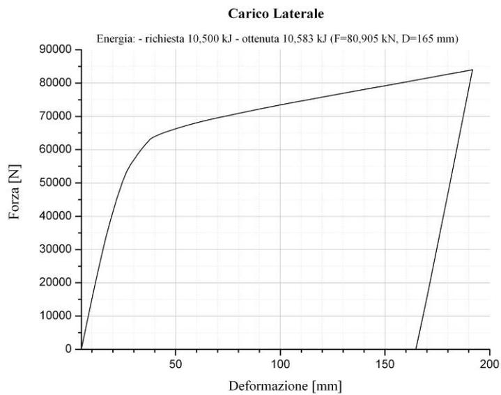
Figura 8. Carico laterale: diagramma Forza vs. Deformazione
