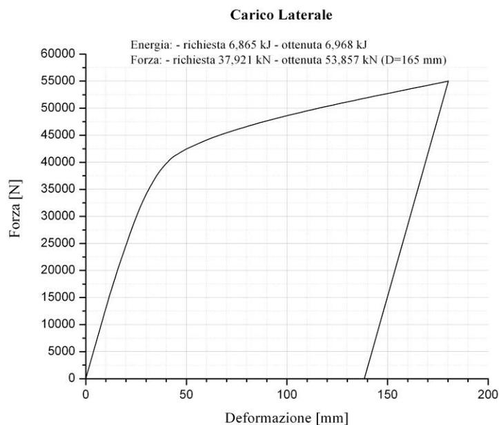
Figura 7. Carico laterale: diagramma Forza vs. Deformazione
