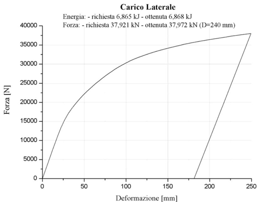
Figura 7. Carico laterale: diagramma Forza vs. Deformazione
