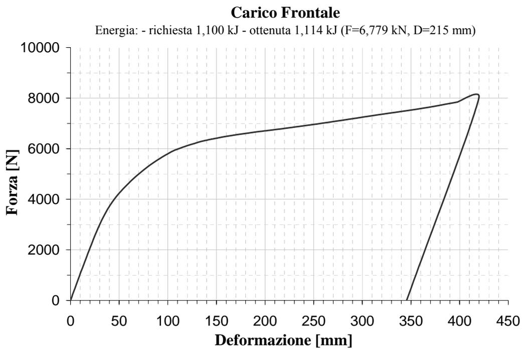
Figura 8. Carico frontale: diagramma Forza vs. Deformazione
