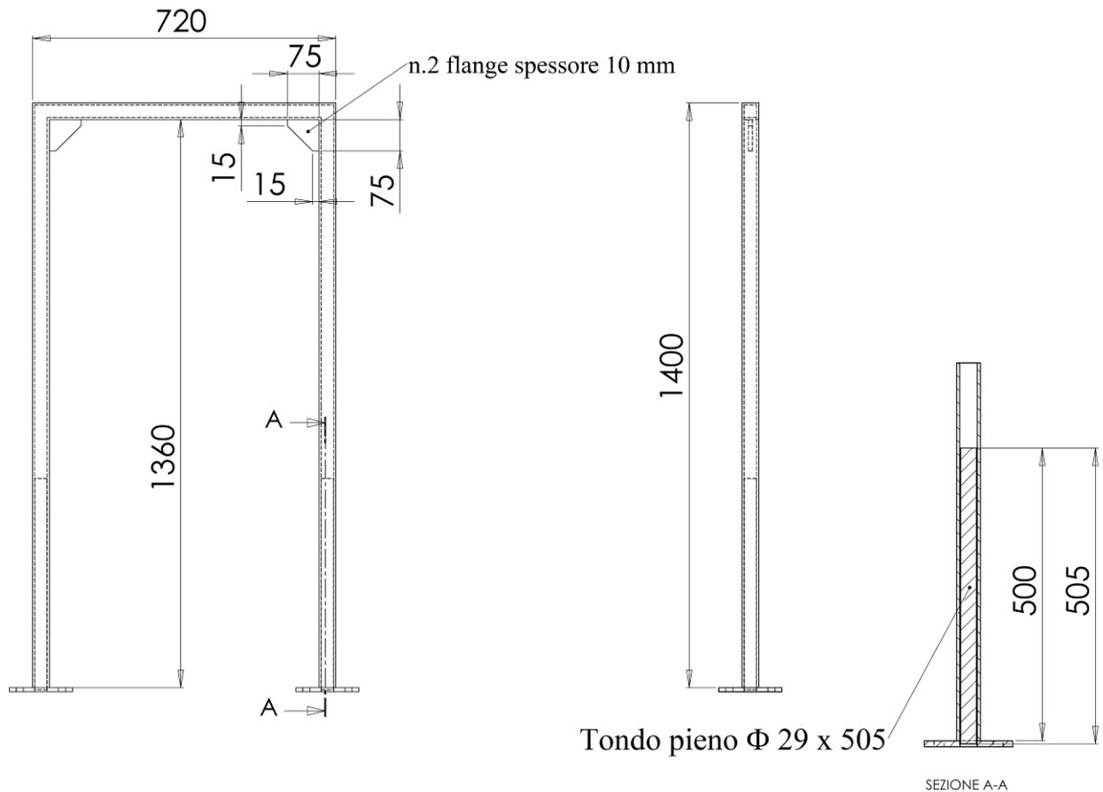
Figura 1. Telaio di protezione posteriore fisso
