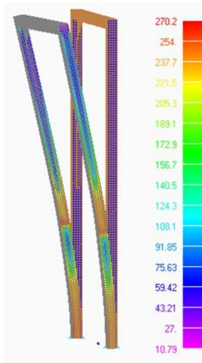
Figura 5. Carico posteriore: diagramma a falsi colori della tensione [MPa]
