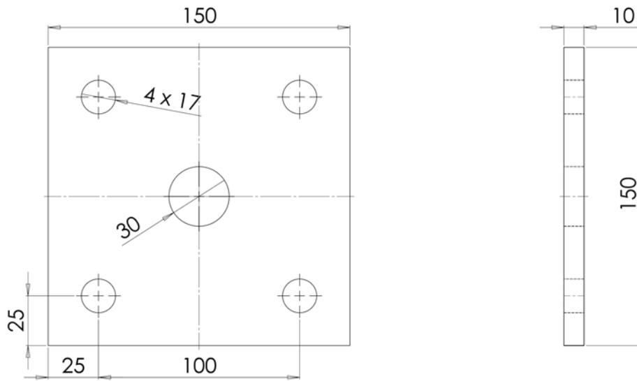
Figura 2. Piastra alla base del telaio
