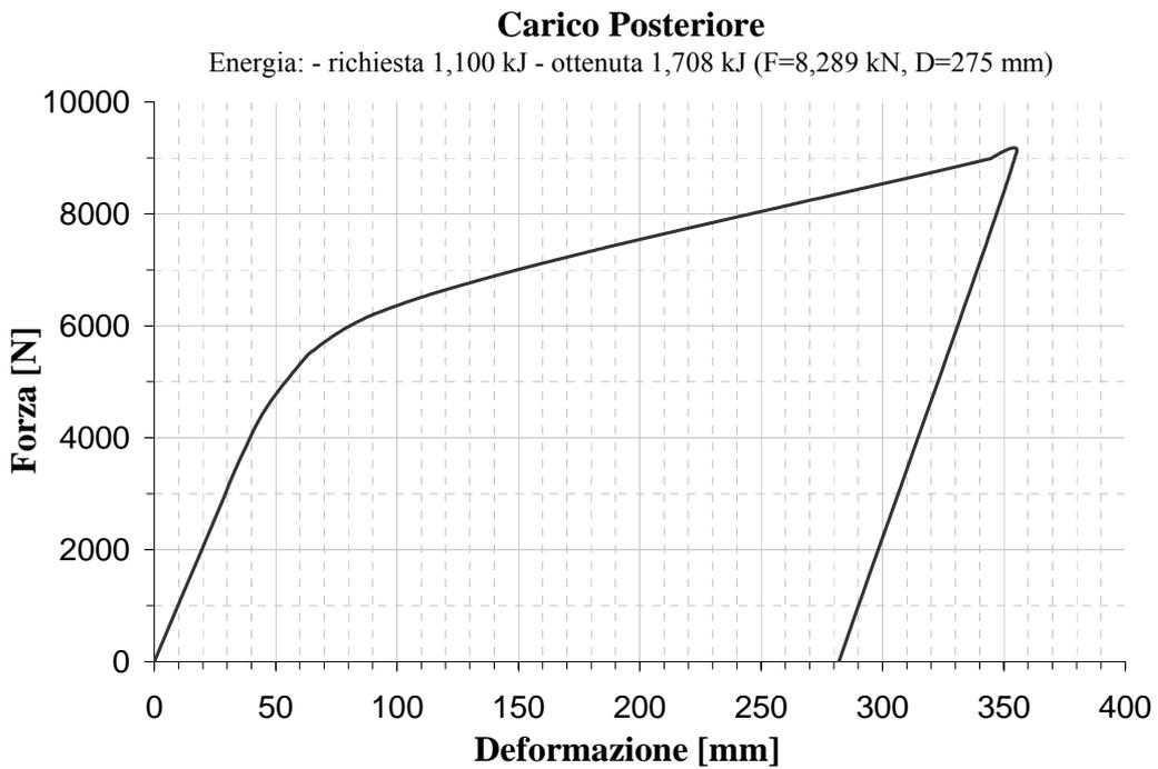
Figura 6. Carico posteriore: diagramma Forza vs. Deformazione
