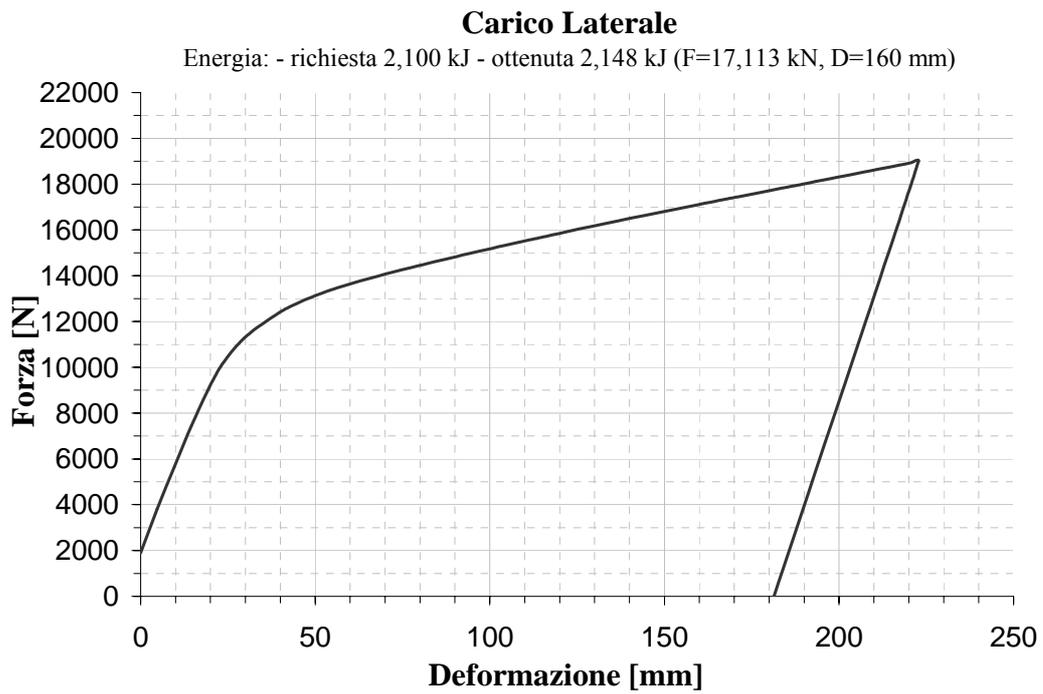
Figura 10. Carico laterale: diagramma Forza vs. Deformazione
