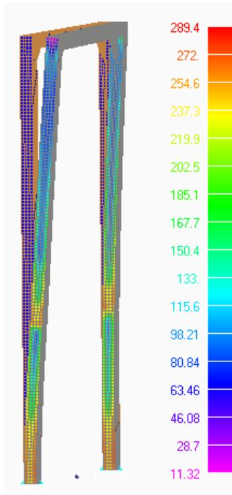
Figura 7. Carico frontale: diagramma a falsi colori della tensione [MPa]
