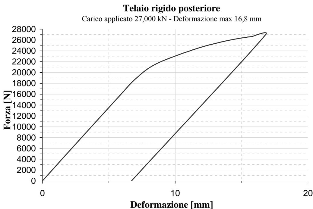
Figura 14. Telaio rigido posteriore: diagramma Forza vs. Deformazione
