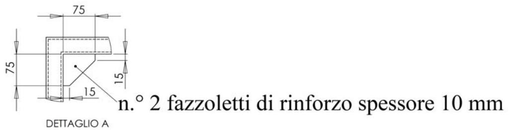
Figura 2. Telaio di protezione anteriore fisso
