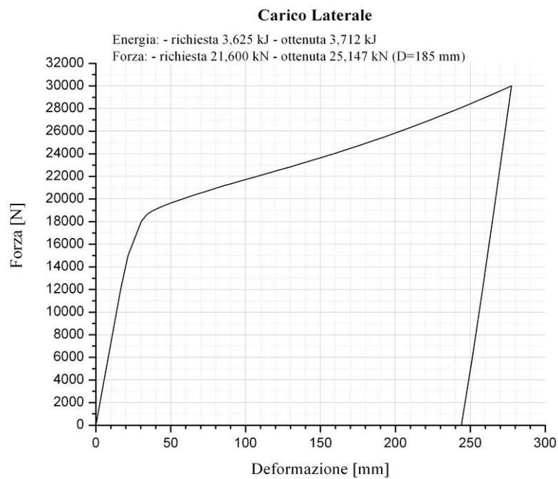
Figura 6. Carico laterale: diagramma Forza vs. Deformazione
