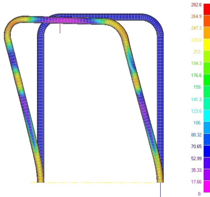
Figura 5. Carico laterale: diagramma a falsi colori della tensione [MPa]
