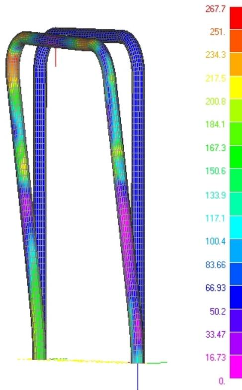
Figura 7. Carico verticale: diagramma a falsi colori della tensione [MPa]
